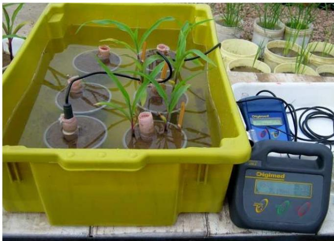
FIGURA 2. Bandeja com encharcamento em solo inundado, mostrando a presença dos tubos para medição da concentração de oxigênio e pH, e os aparelhos medidores (oxímetro e potenciômetro).
