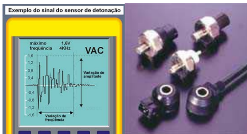
Figura (2.8). Sensores de Detonação. Fonte: [Injetronic, 2003].
