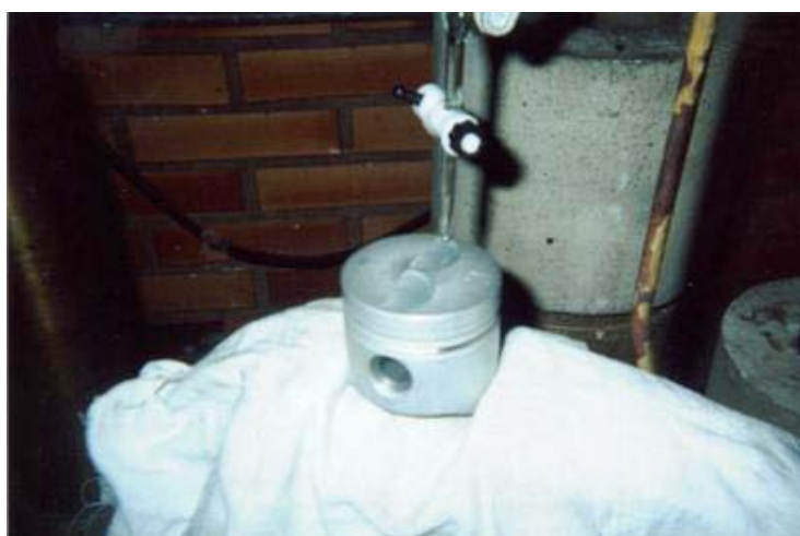
Figura (3.6). Medição do volume do recuo de válvulas.
