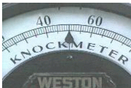
Figura (2.17). Knockmeter utilizado na leitura da intensidade de detonação.
