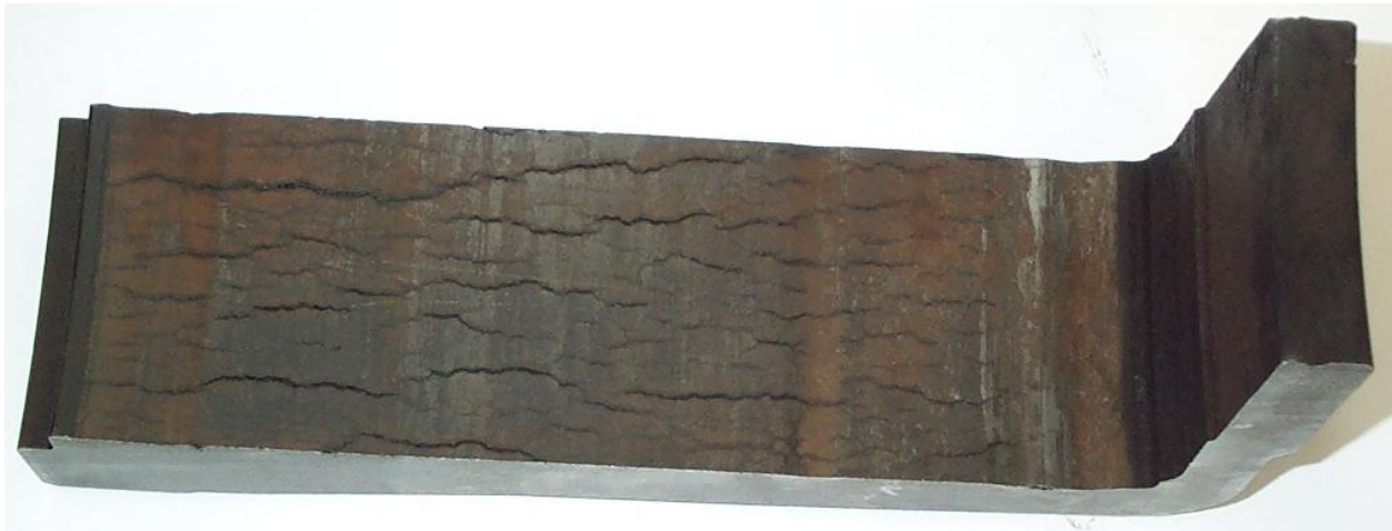
Figura 4.11: Comprimento das trincas e sua distribuição
