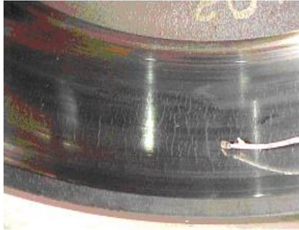
Figura 3.9: Trincas térmicas e estrias em tambor de freio (Fonte: Acervo do autor)
