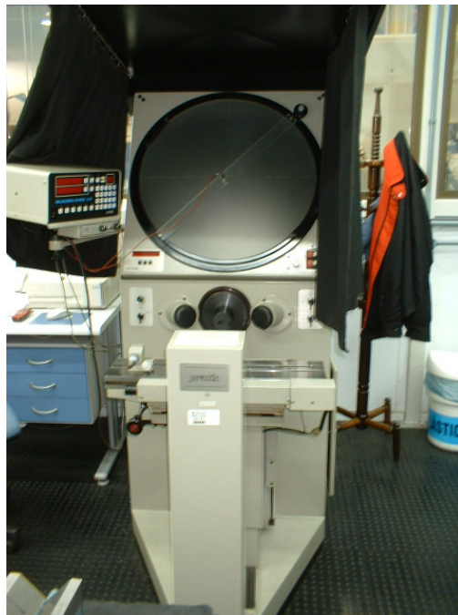
Figura 3.18: Projetor de perfil (Fonte: Acervo do autor)
