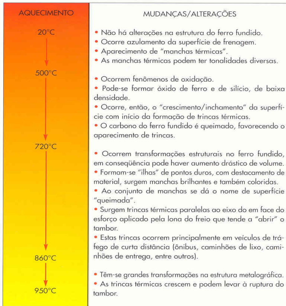
Figura 3.7: Transformações na estrutura do Ferro Fundido Cinzento com a temperatura
