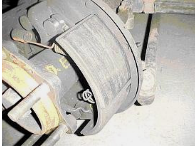
Figura 3.11: Freio tipo S-Came utilizado (Fonte: Acervo do autor)
