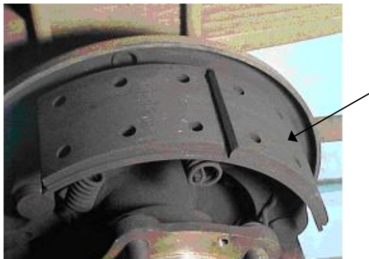
Figura 3.12: Lonas de freio montadas no freio (Fonte: Acervo do autor)
