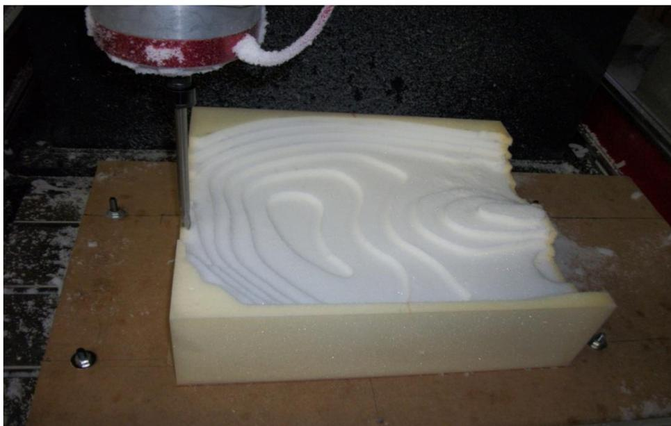
Figura 34: Usinagem CNC do assento da cadeira de rodas.
