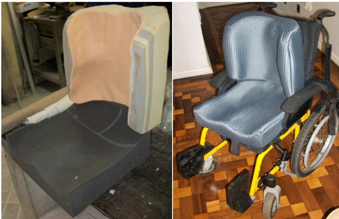
Figura 31: Assentos: a) Assento e encosto sem acabamento b) Assento e encosto com acabamento.
