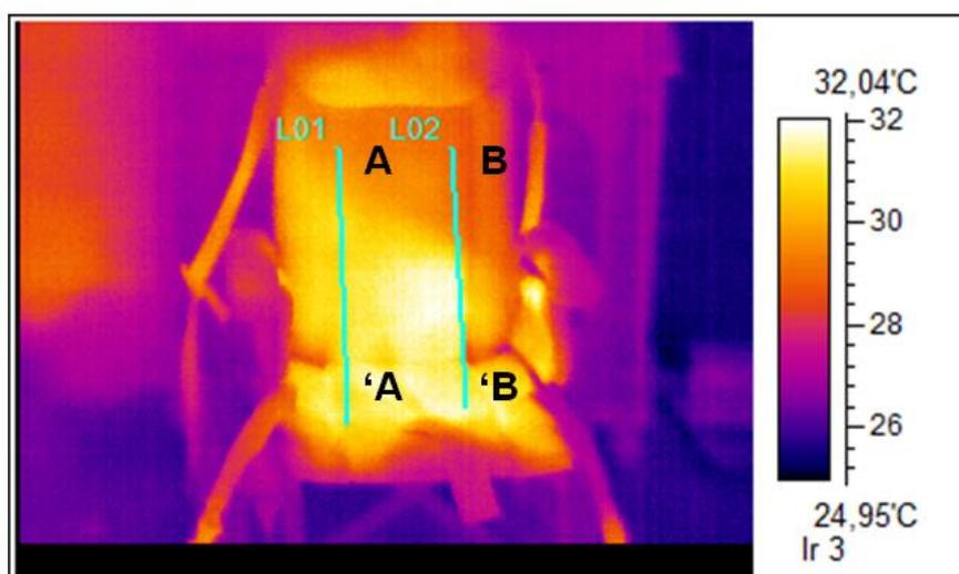
Figura 37: Termografia da cadeira de rodas do sujeito (Software Sat Report).
