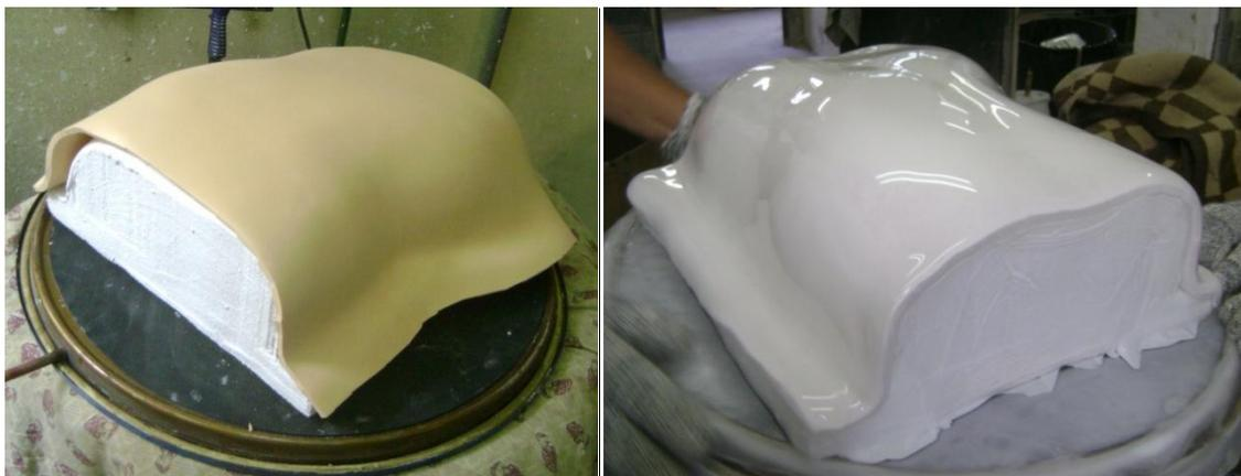
Figura 27: Termomoldagem EVA e termomoldagem PP.
