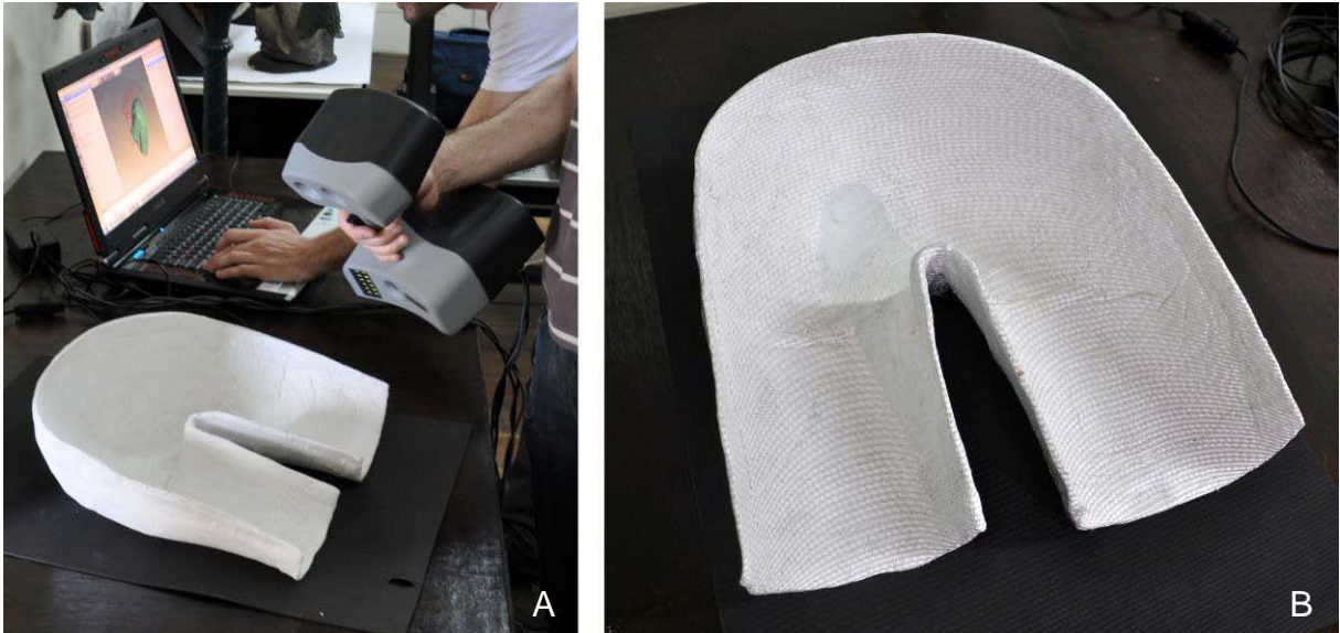
Figura 41 - Digitalização do molde de gesso com Scanner Artec MHT, Museu Nacional/UFRJ (A) com detalhe do padrão de luz branca projetado na superfície do objeto (B).
