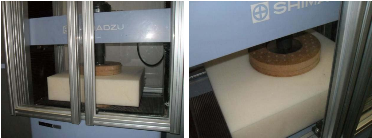
Figura 29 - Ensaio de indentação em espuma flexível de poliuretano, LACER/UFRGS.
