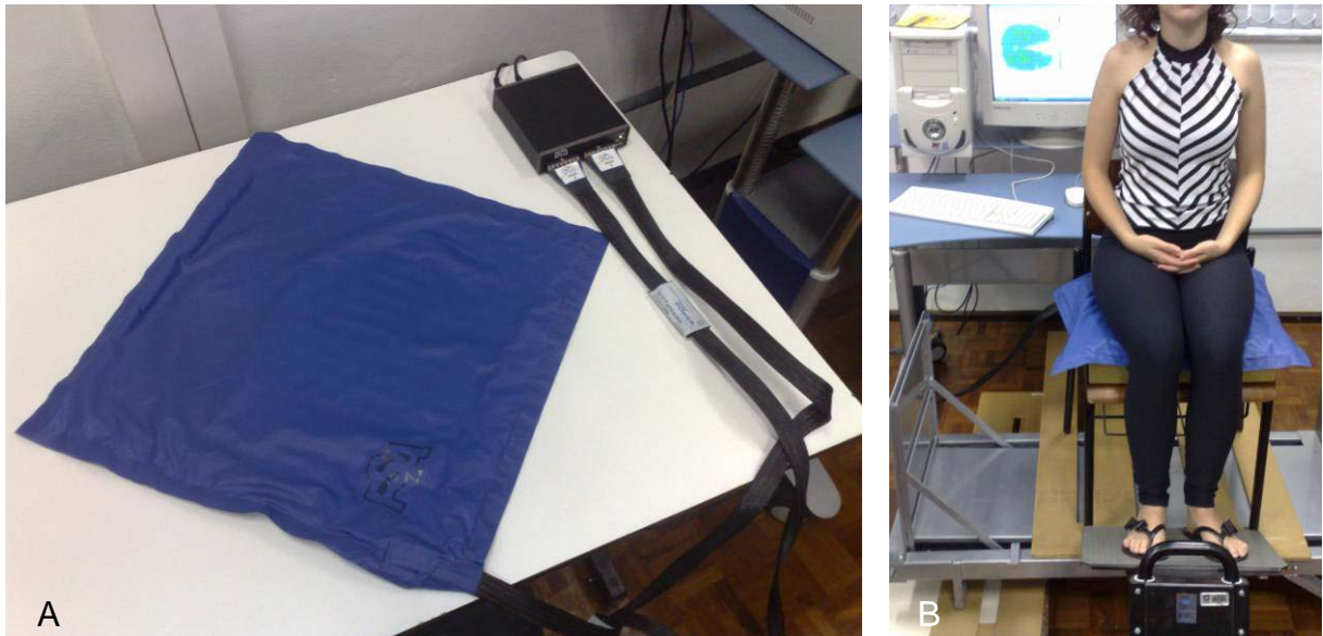
Figura 61 - Sistema de Mapeamento de Pressão FSA, CENT/CARVI/UCS.
