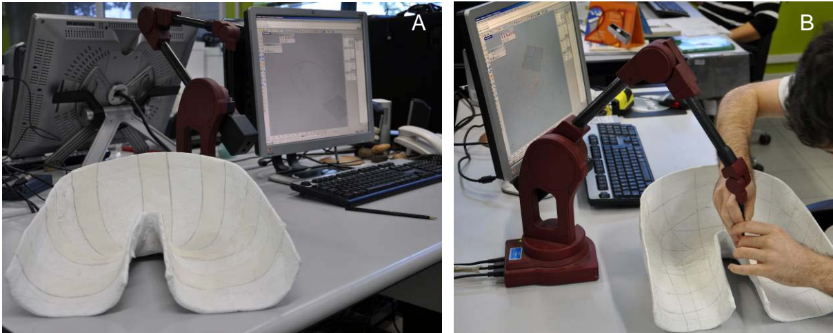
Figura 55 - Marcação (A) e aquisição dos pontos (B) com o Microscribe 3D, DvDI/INT.
