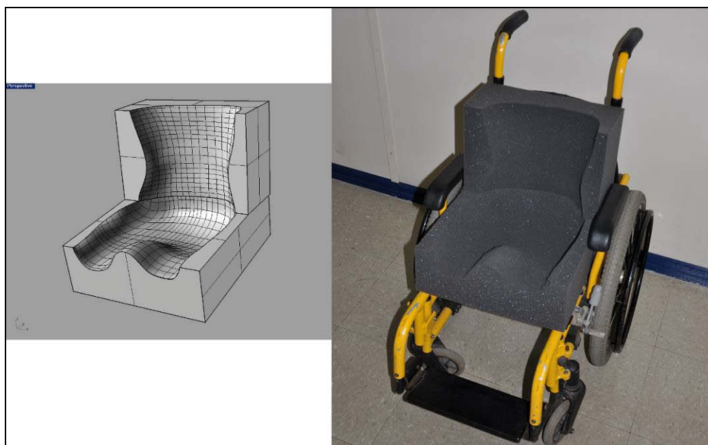
Figura 122 - Assento virtual e assento produzido para o usuário D.
