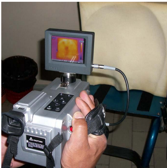
Figura 62 - Análise da distribuição de temperatura com Termógrafo HY6800, LACER/UFRGS.
