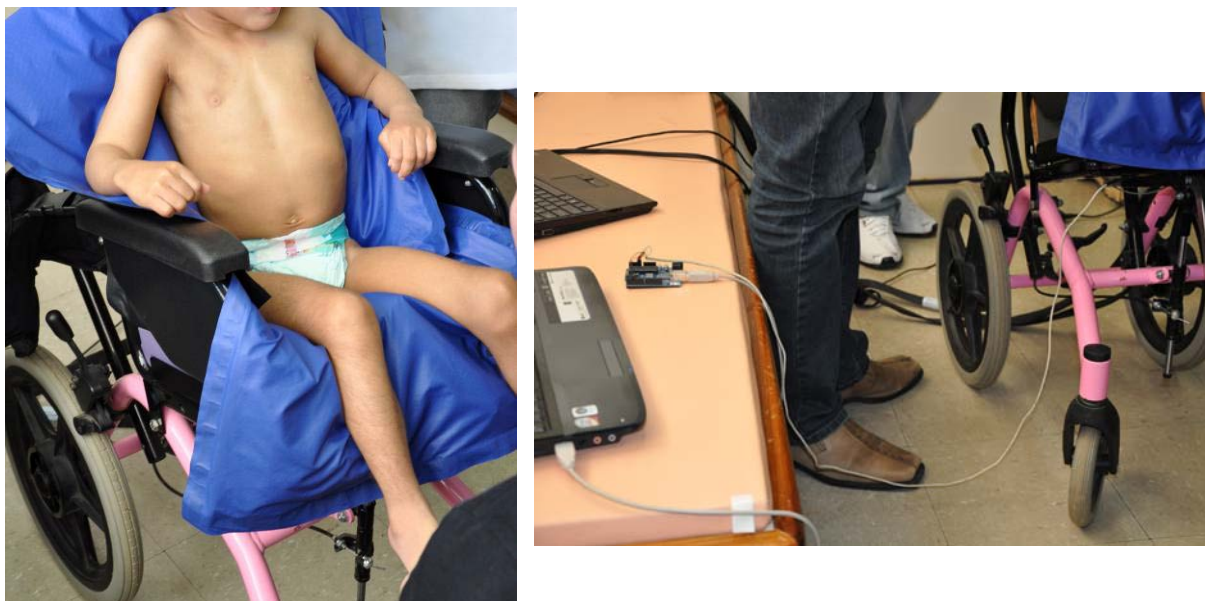
Figura 117 - Mapeamento de pressão e avaliação do ângulo de tilt via acelerometria.
