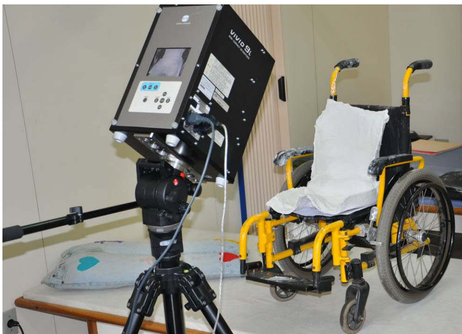
Figura 121 - Digitalização tridimensional do molde de gesso do usuário D.
