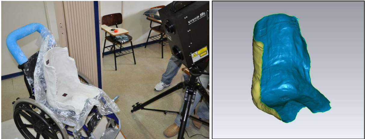
Figura 102 - Digitalização tridimensional do molde de gesso do usuário A.
