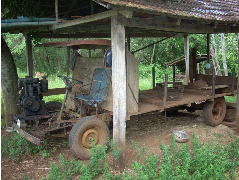
Figura 11 – Carreta agrícola motorizada utilizada para o transporte da cana – UPA 2
