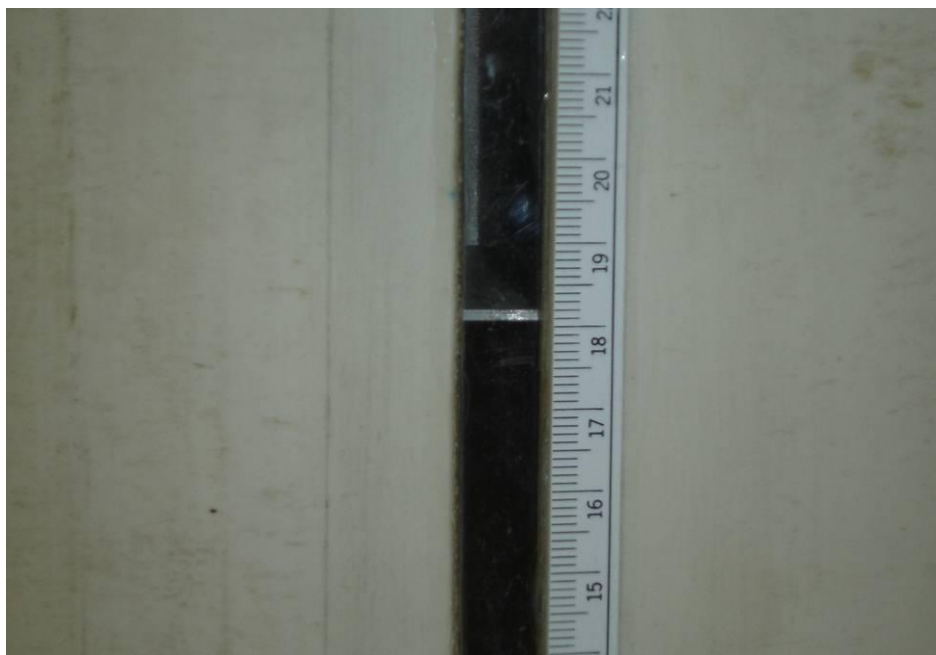
Figura 18: êmbolo dentro do cilindro permitindo a leitura na régua
