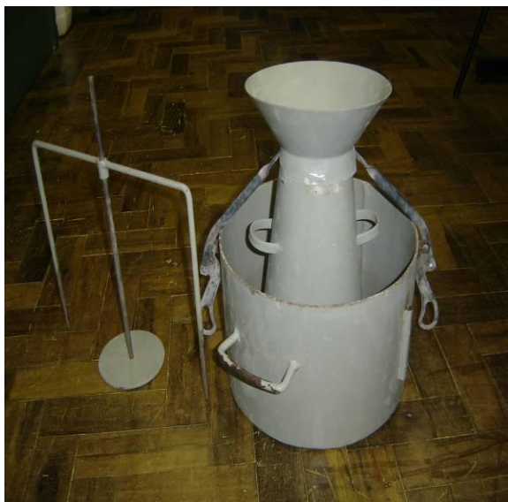
Figura 30: equipamento empregado no ensaio de remoldagem simplificado
