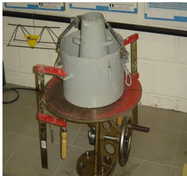
Figura 31: conjunto montado sobre a mesa de consistência
