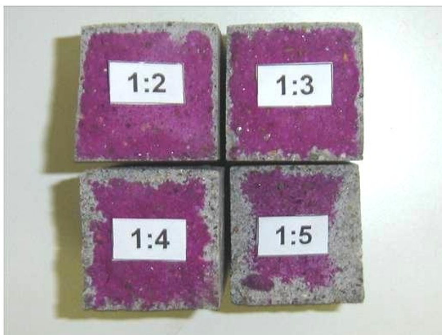
Figura 13: verificação da evolução da frente de carbonatação avaliada em corpos de prova com 25 semanas de idade
