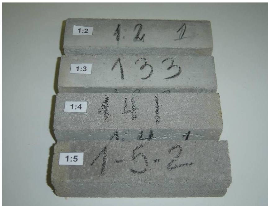
Figura 12: corpos de prova prismáticos após a desforma
