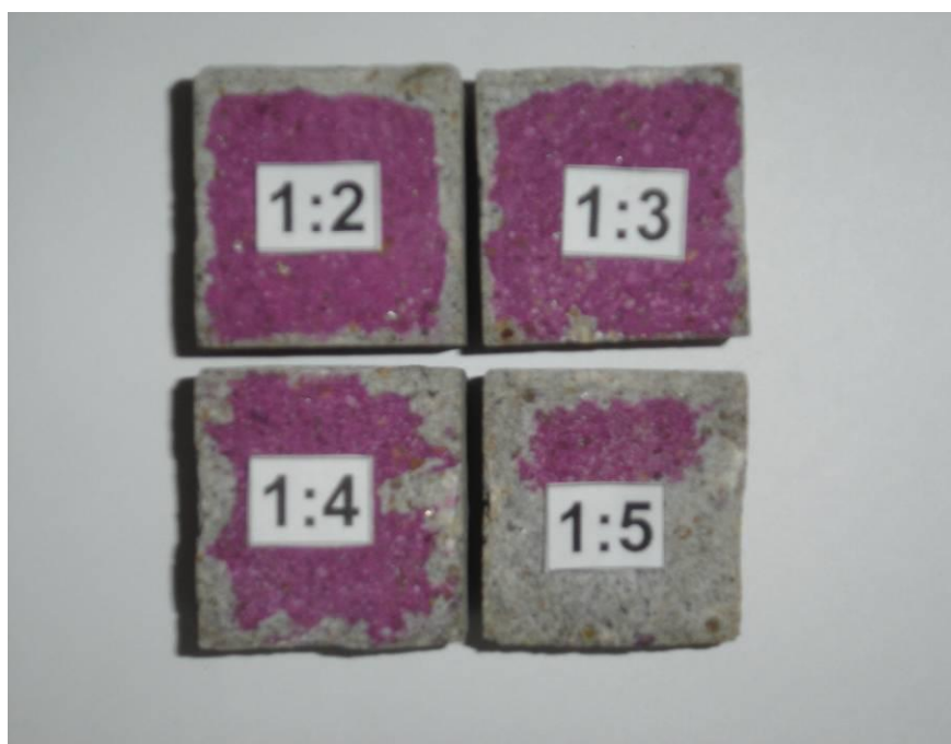
Figura 14: verificação da evolução da frente de carbonatação com 118 semanas de idade
