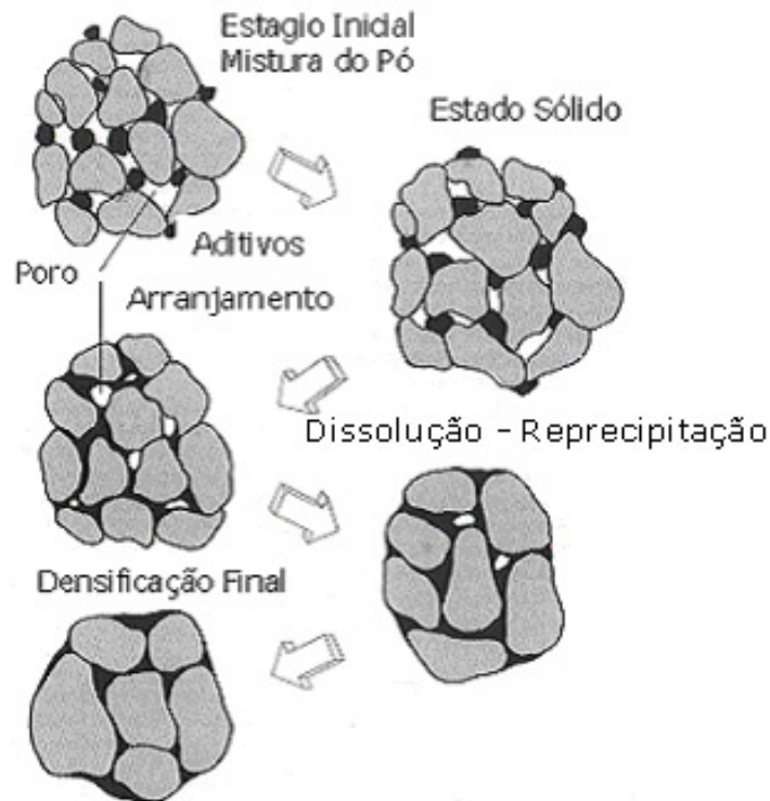
Figura 24 - Estágio da sinterização por fase líquida. Adaptado [9].
