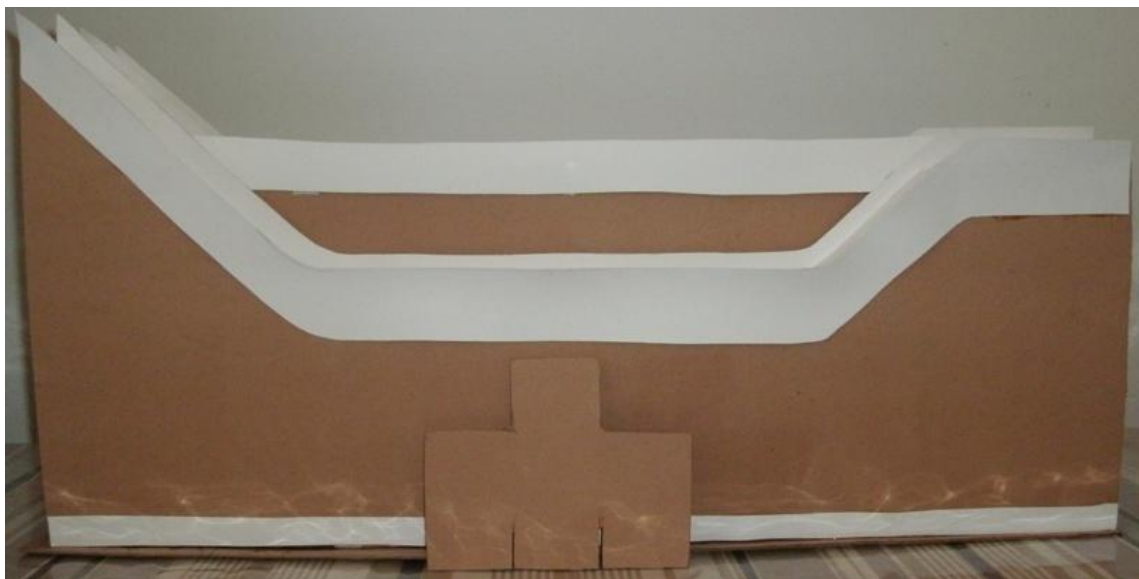
Figura 5 - Imagem lateral do experimento mostrando o caminho do trilho III e, ao fundo, do trilho II. Também é mostrada a régua usada para garantir que todas as esferas saiam ao mesmo tempo.
