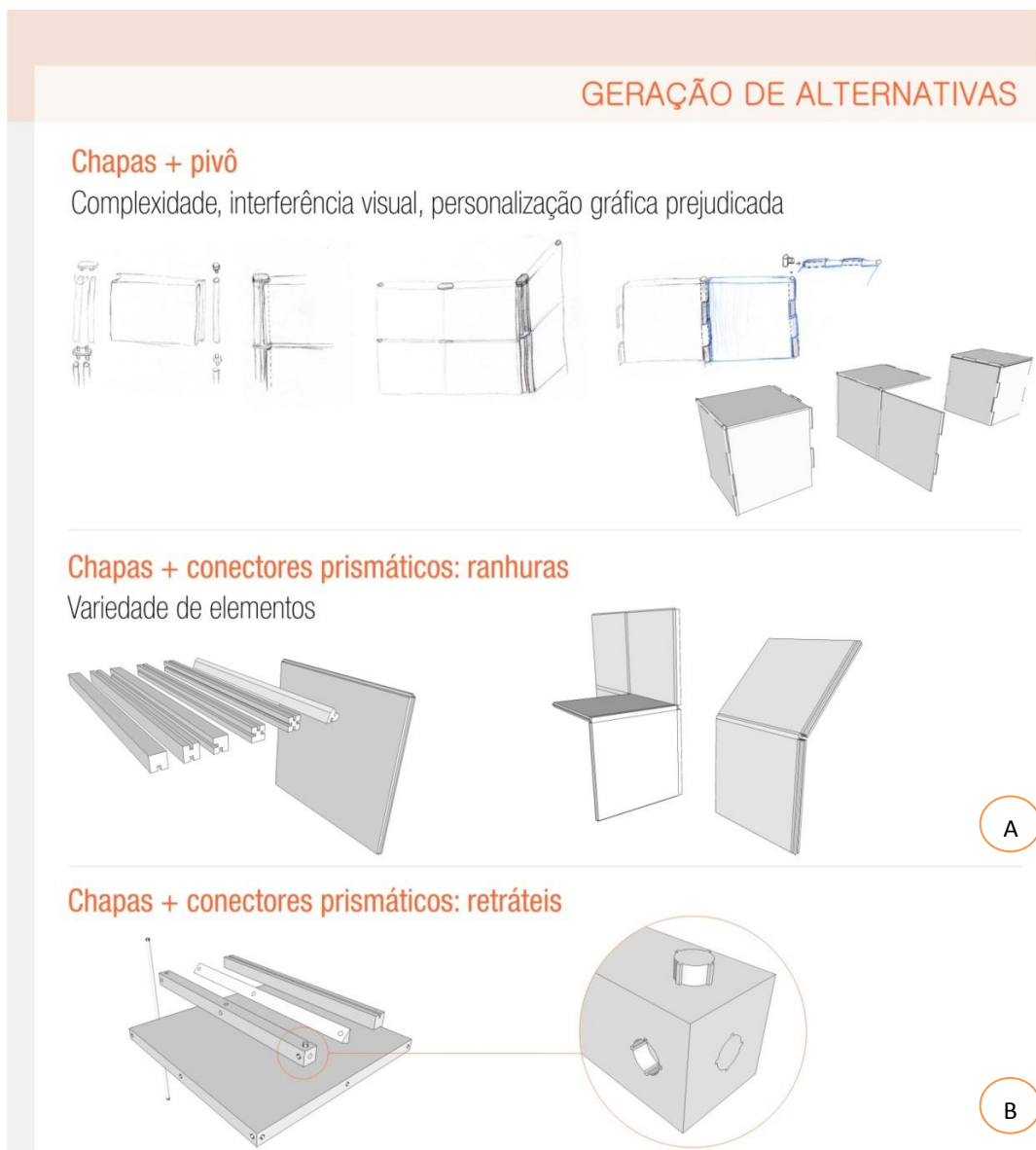
Quadro 12: Geração de alternativas, problemas encontrados, e (A) e (B) - soluções a analisar. Fonte: Autor.
