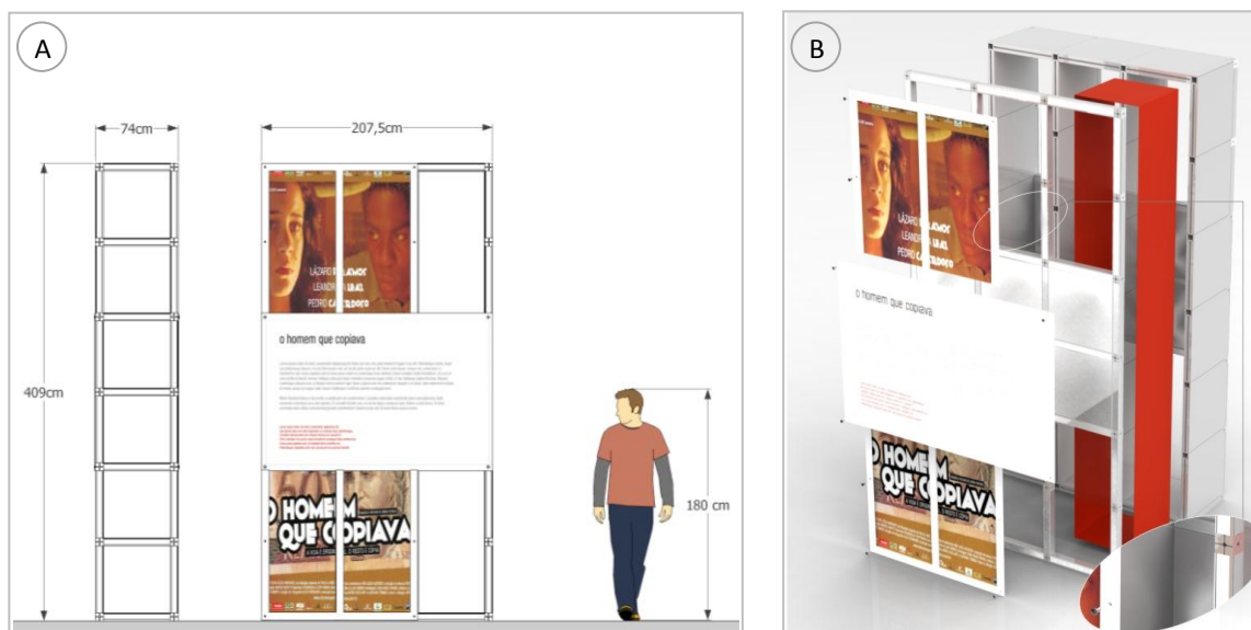
Figura 154: (A) Elemento 9: painel de destaque. (B) Exemplo de fixação de painéis acessórios e adesivo vermelho. Fonte: Autor.
