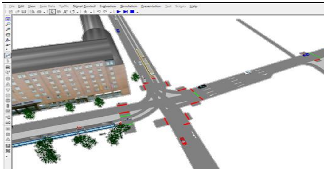
Figura 3.19: Exemplo de controladores configurados no VISSIM. As linhas vermelhas representam estes controladores.
