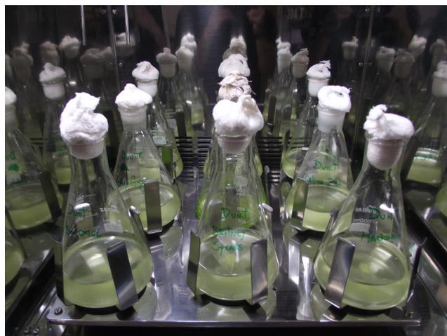
Figura 11: Estufa rotatória com os pré-inóculos das microalgas *D. tertiolecta*.
