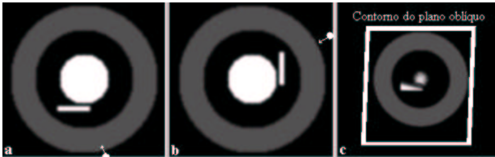
FIGURA 3.4 – Exemplo de (a) um corte axial, (b) um corte sagital e (c) uma seção oblíqua determinada arbitrariamente, onde as linhas identificam os limites da seção
