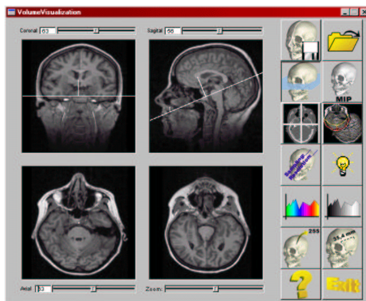
FIGURA 7.5 – Extração de um plano de corte oblíquo - as linhas brancas são usadas para posicionar o plano
