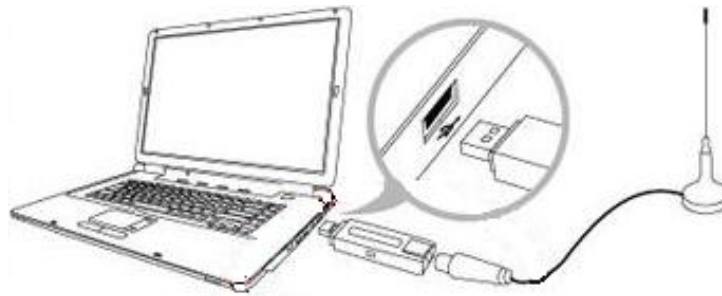
Figura 14. Conversor USB conectando um nó da rede ao computador.
