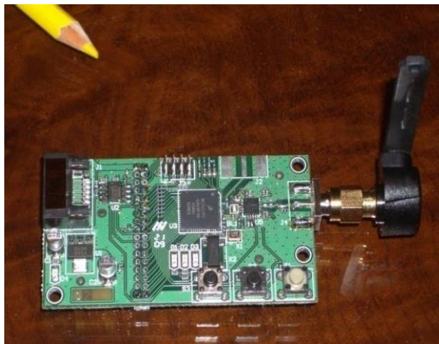
Figura 2. Exemplo de dispositivo de campo WirelessHART .
