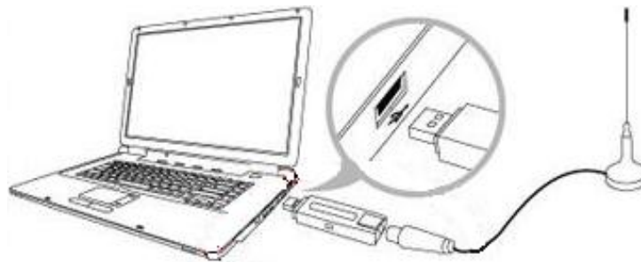
Figura 3. Conversor USB conectando o radio ao computador.
