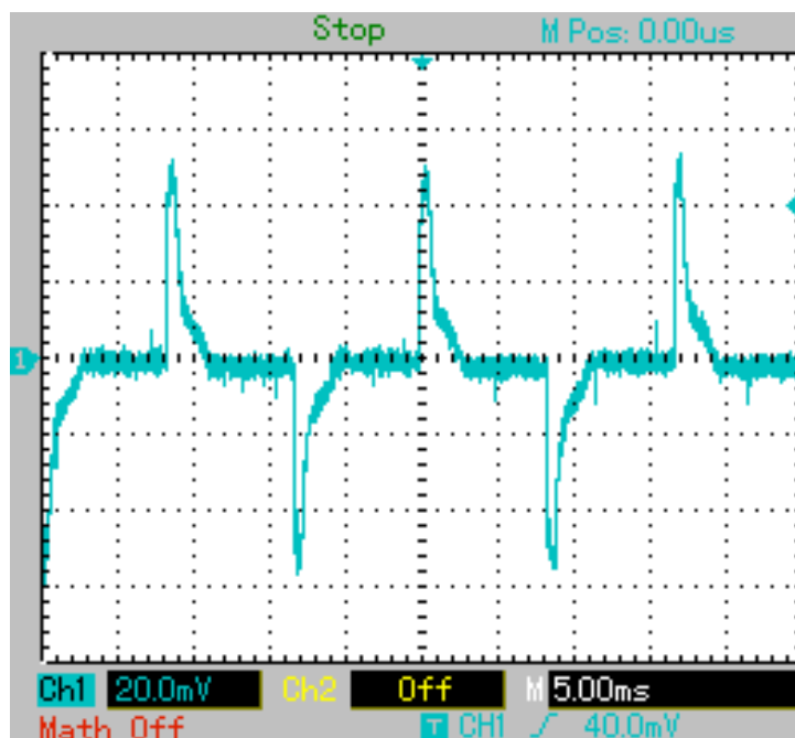
Figura 5.12. Sinal de corrente para lâmpada fluorescente capturado com acoplamento AC.
