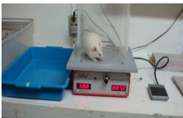
Figura 05: Aparelho utilizado no teste da placa quente. Note o rato sobre a placa quente, cujos indicadores luminosos mostram temperatura de 50° C (à esquerda) e marcador de tempo em segundos (à direita).
