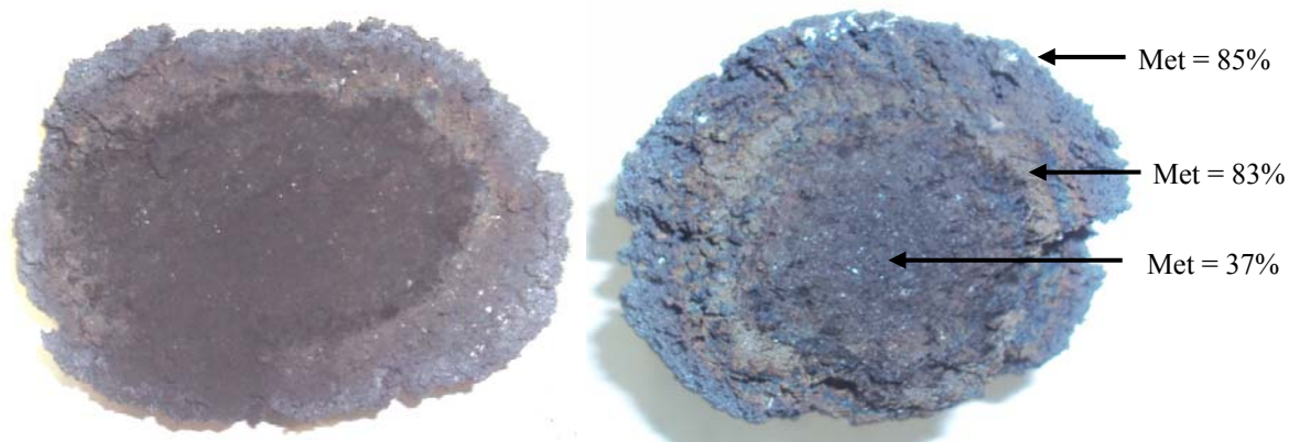
Figura 4.32 - Análise visual da (a) seção longitudinal e (b) transversal do B1 após os testes de alta temperatura (33% de perda de massa) e os valores de metalização das diferentes camadas.
