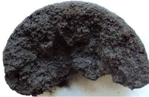
Figura 4.20 - Fragmento do briquete resultante de um teste com 39% de perda de massa em macrotermobalança.
