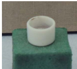
Figura 1.12 - Cadinho de alumina utilizado nos testes em termobalança.
