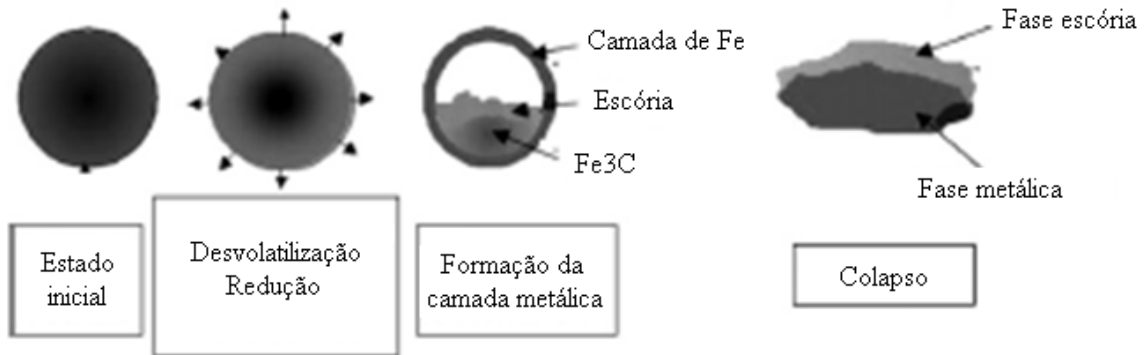
Figura 4.2 - Sequência de eventos que ocorrem durante o aquecimento de uma pelota autorredutora (Gudenau et al., 2005).
