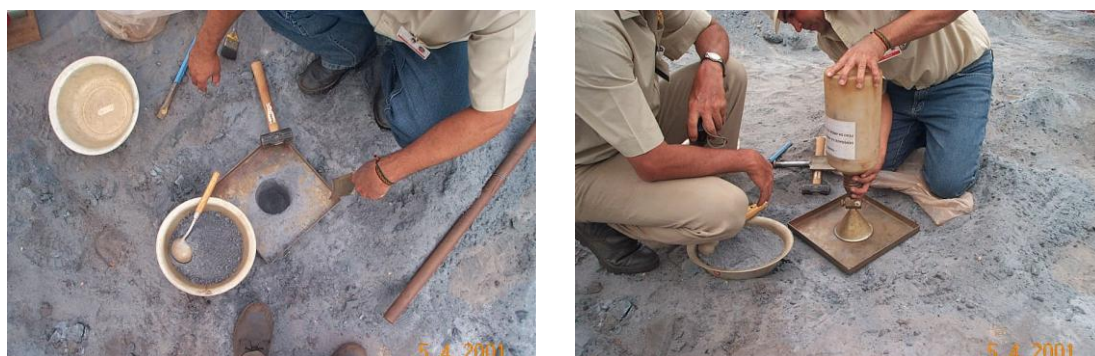
Figura 2.1 – Realização do ensaio de densidade pela Técnica do Frasco de Areia (Santos, 2006).
