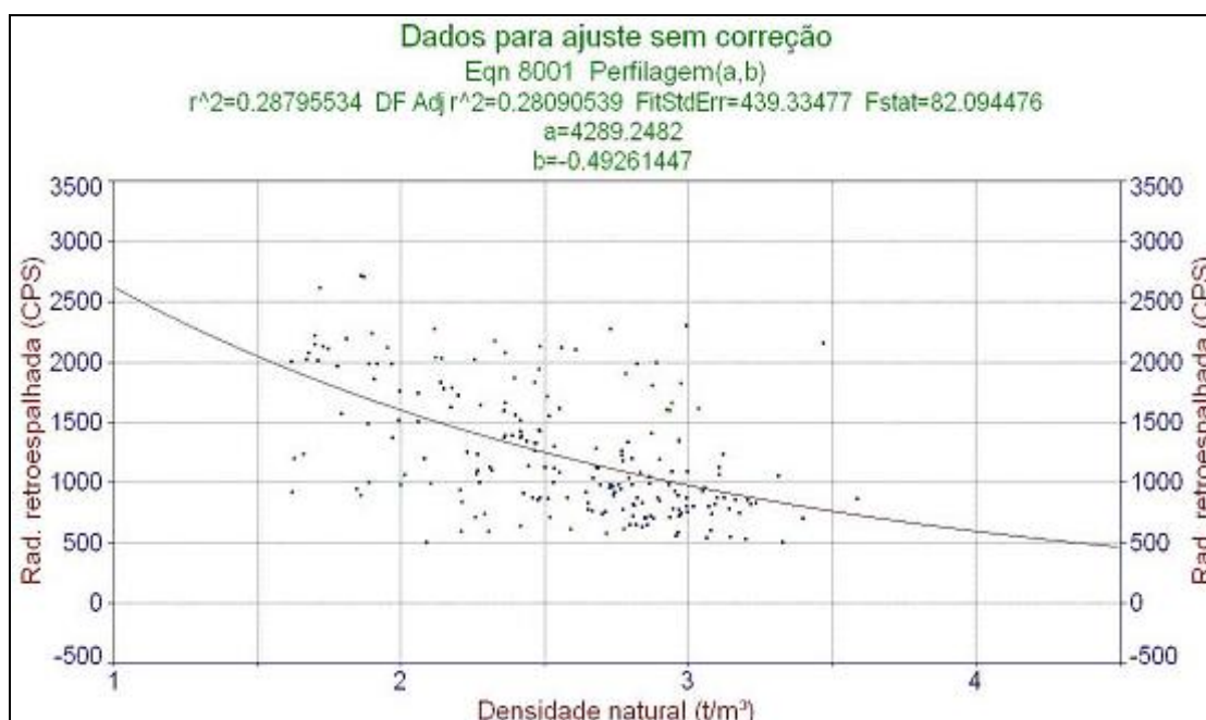
Figura 5.1 - Plotagem de contagens (CPS) para o sensor HRD versus densidades naturais, obtidas por análises de laboratório, para o conjunto completo de amostras de testemunhos de sondagem (dados de Dois Irmãos e Maquiné).
