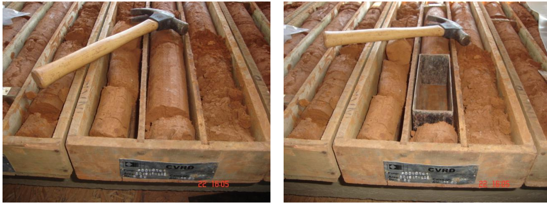
Figura 2.3 – Realização do ensaio de densidade pela Técnica do Gabarito Retangular (Santos, 2006).
