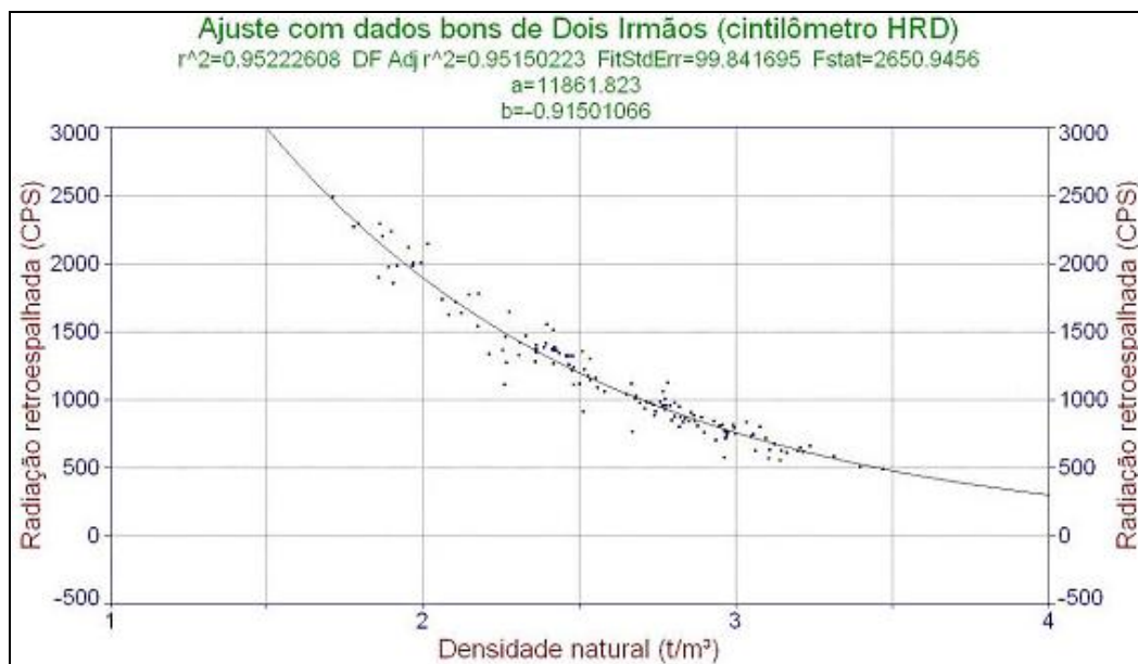
Figura 5.6 - Curva de ajuste obtida para o cintilômetro HRD com dados válidos de furos de sondagem do Alvo Dois Irmãos (Tabela A.2, Anexo 1). Coeficientes para a função de densidade: a=11861,823 e b=0,91501066 .
