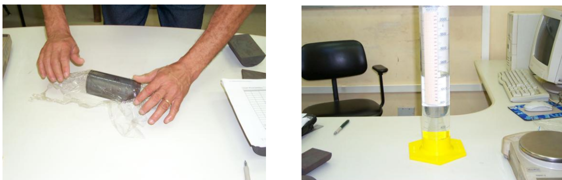
Figura 2.2 – Realização do ensaio de densidade pela Técnica do Meio Denso por Deslocamento de Volume de Água (Santos, 2006).
