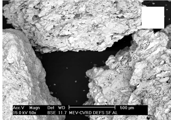
Figura 2.6 – Minério da porção central do Quadrilátero Ferrífero - Minério hematítico com percentagens elevadas de goethita/limonita, magnetita e minérios de ganga. (Fonte: Caracterização Mineralógica CVRD, 2002).
