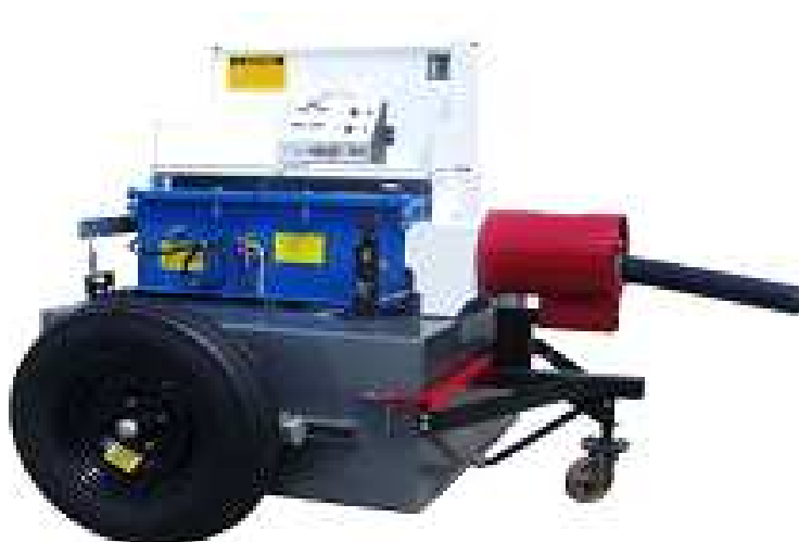
Figura 2.24 - Dinamômetro para TDP AW Dynamometer INC modelo NEB 600.
