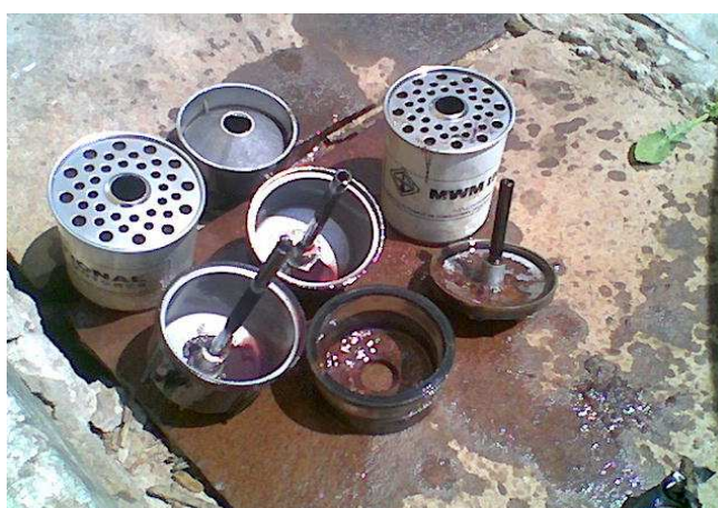
Figura 4.8 - Presença de materiais sólidos nos filtros de combustível de alguns modelos.
