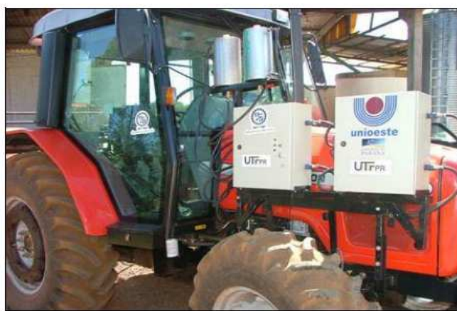
Figura 2.15 - Sistema de medição de consumo produzido por Marchetti (2006)
