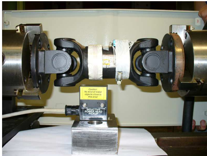
Figura 3.39 – Detalhe do dispositivo usado para aplicar diferentes níveis de torque ao eixo no processo de calibração do sistema de telemetria responsável por esta medição.
