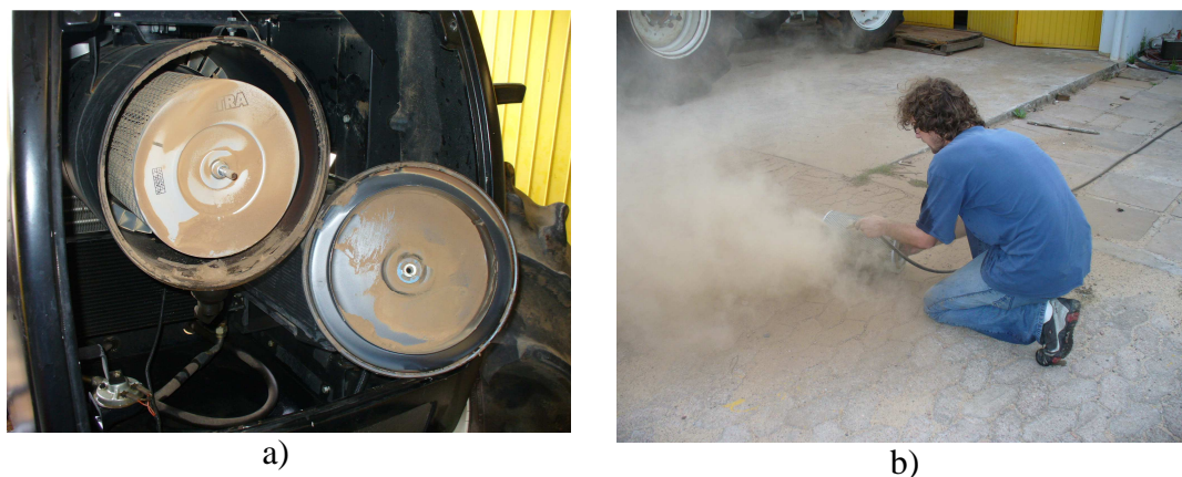
Figura 4.7 - a) Presença de poeira nos filtros de ar do motor ; b) Limpeza dos filtro de ar.
