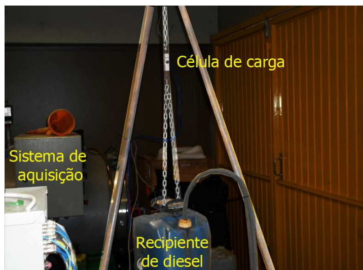
Figura 3.25 – Configuração da balança de combustível utilizada.
