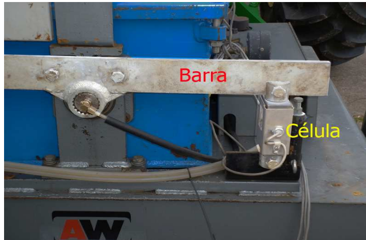
Figura 3.7 - Detalhe da célula de carga e da barra de reação encontrados no dinamômetro.
