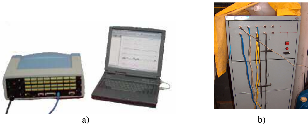
Figura 3.5 - Sistema de aquisição de dados: a) Módulo de aquisição ADS 2000 da Lynx e o microcomputador utilizado; b) Armário metálico contendo o módulo de aquisição e conexões elétricas.
