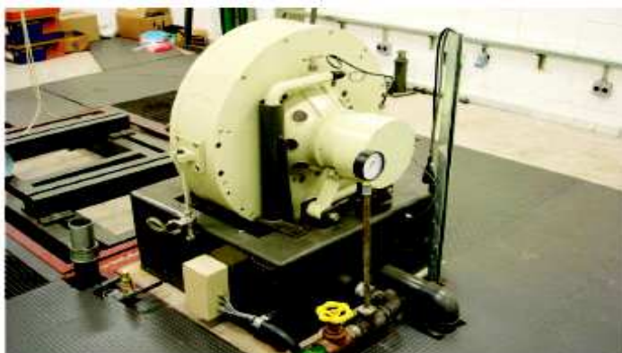
Figura 2.18 – Exemplo de dinamômetro de corrente de Foucault.
