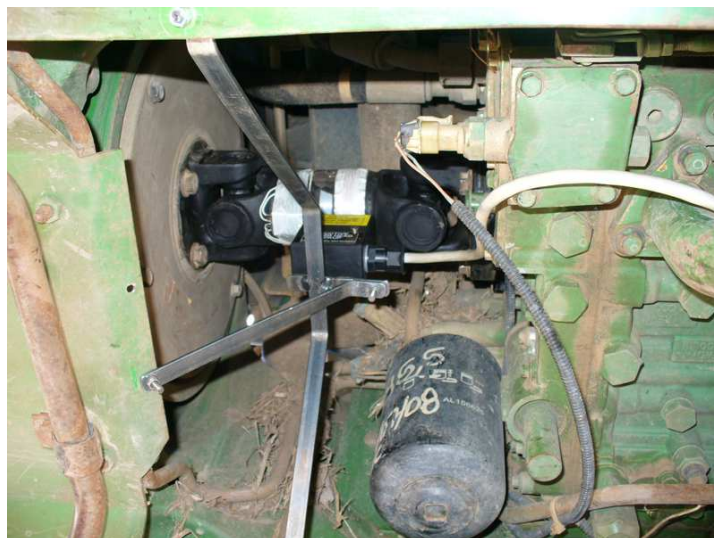
Figura 3.40 – Sistema de medição de torque montado no trator.
