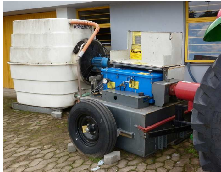
Figura 3.3 – Visão geral do dinamômetro e da torre de arrefecimento.
