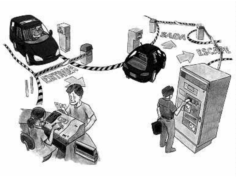
FIGURA 5 – Esquema de funcionamento de uma garagem self-parking
