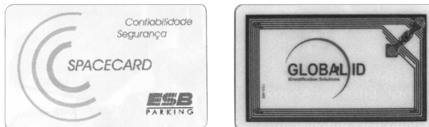
Exemplo de cartão "chipado" (na parte de trás está impressa a antena e o chip).
