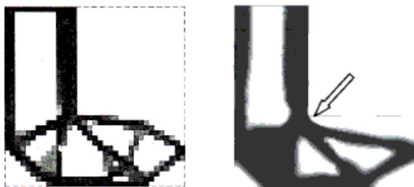
Figura 7.38: Distribuições de densidade obtidas por: (A) Duysinx e Bendsøe [Duysinx e Bendsøe, 1998] usando uma malha com 1225 elementos quadriláteros com 9 nós e (B) Pereira [Pereira, 2001], utilizando uma malha com 5218 elementos triangulares CST. A região destacada mostra a solução correta para eliminar as concentrações de tensão geradas pelo canto-vivo.
