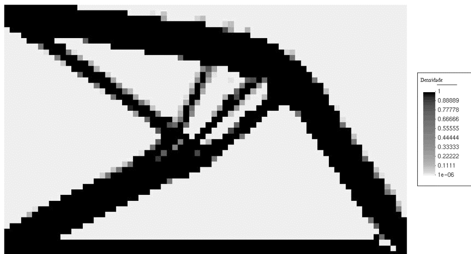
Figura 7.23: Topologia obtida com função objetivo penalizada ( p=1/8 , \alpha=0,3 ) e filtro gaussiano desativado.
