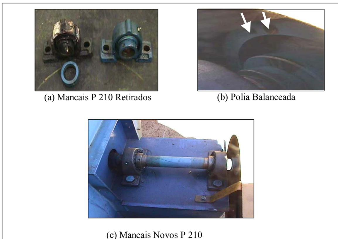
FIGURA 6.11 : DEFEITO PROVOCADO NOS MANCAIS PELO DESBALANCEAMENTO.
