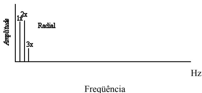
FIGURA 3.10 : ESPECTRO DE DESALINHAMENTO PARALELO.
