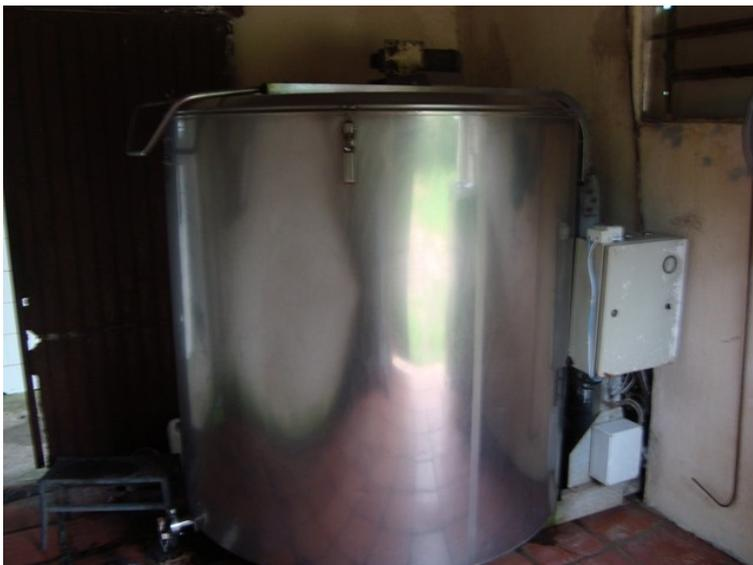
Fotografia 9: Resfriador utilizado para armazenamento do leite (COOPAN)
