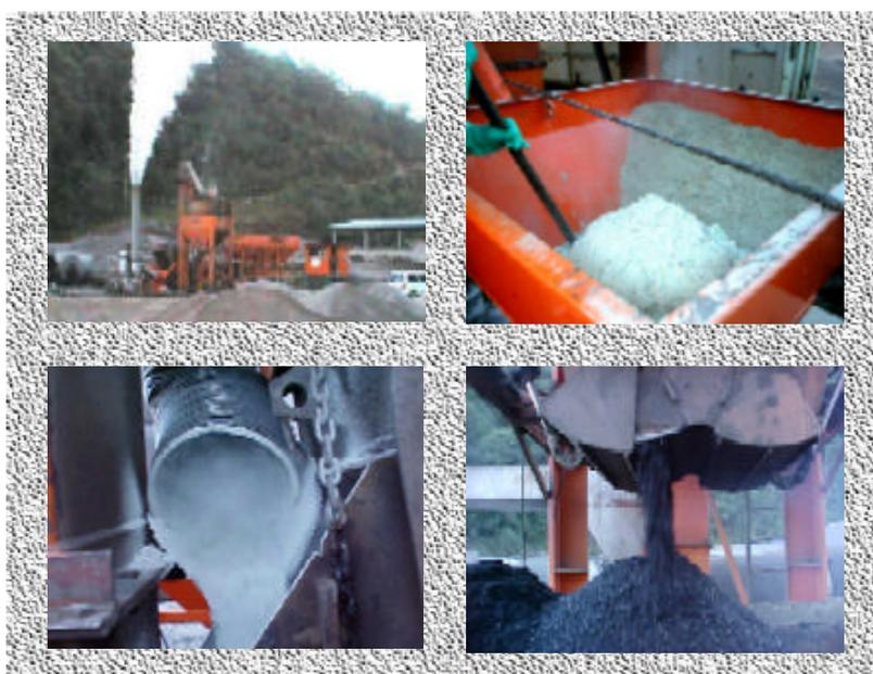
Figura 7.2 Adição da fibra de vidro na mistura betuminosa na usina
