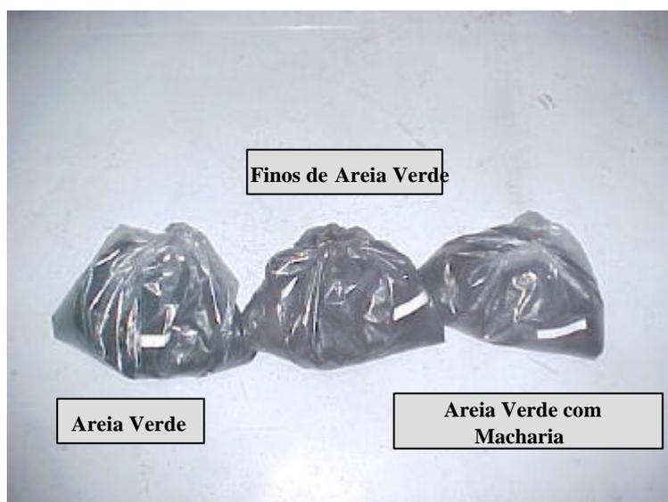
Figura 3.3 Amostras homogêneas das areias de fundição descartadas
