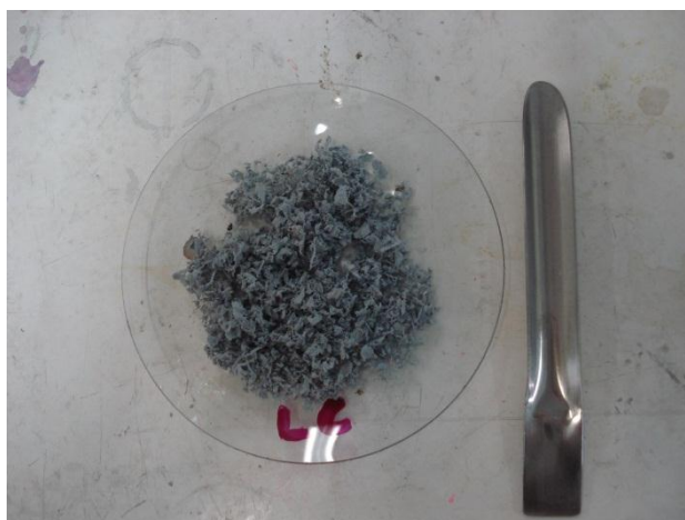
Figura 3.1: Resíduo de couro curtido ao cromo utilizado nos experimentos
