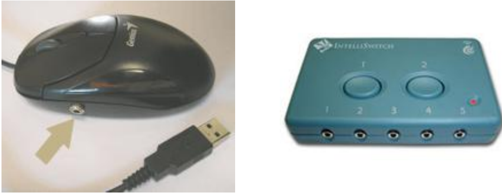
Figura 33 - Mouse adaptado PlugMouse (Clik) disponível na lista de produtos do Projeto Piloto UFRGS/MCT e interface para acionadores IntelliSwitch (Intellitools).
