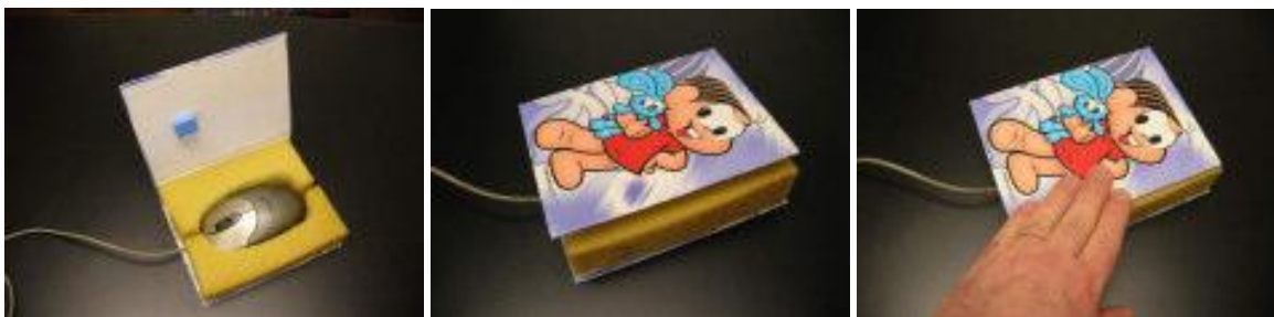
Figura 46 - Mouse transformado em acionador artesanal com sistema de caixa. Fonte: BERSCH (2006)
