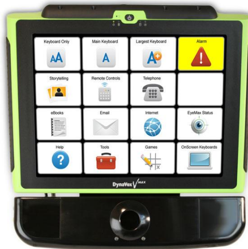
Figura 10 - Recurso de CAA de alta tecnologia para seleção através do direcionamento do olhar Dynavox Vmax e Eyemax. Fonte: Dynavox.
