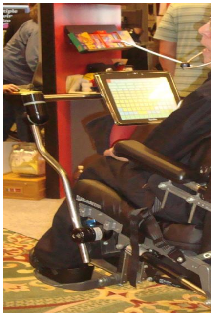
Figura 45 - Rick e seu sistema de comunicação alternativa fixado na cadeira de rodas com acesso através de ponteira de cabeça e tela de toque. Fonte: Arquivo da pesquisadora.
