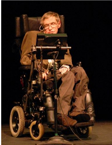
Figura 44 – Stephen Hawking e seu sistema de comunicação alternativa fixado na cadeira de rodas com acesso através de acionador por infravermelho. Fonte: Internet.
