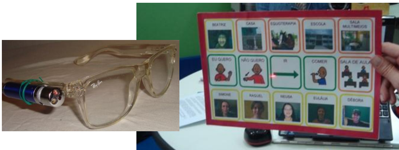
Figura 67 - Caneta laser pointer fixada em armação de óculos para acesso às pranchas de comunicação.
