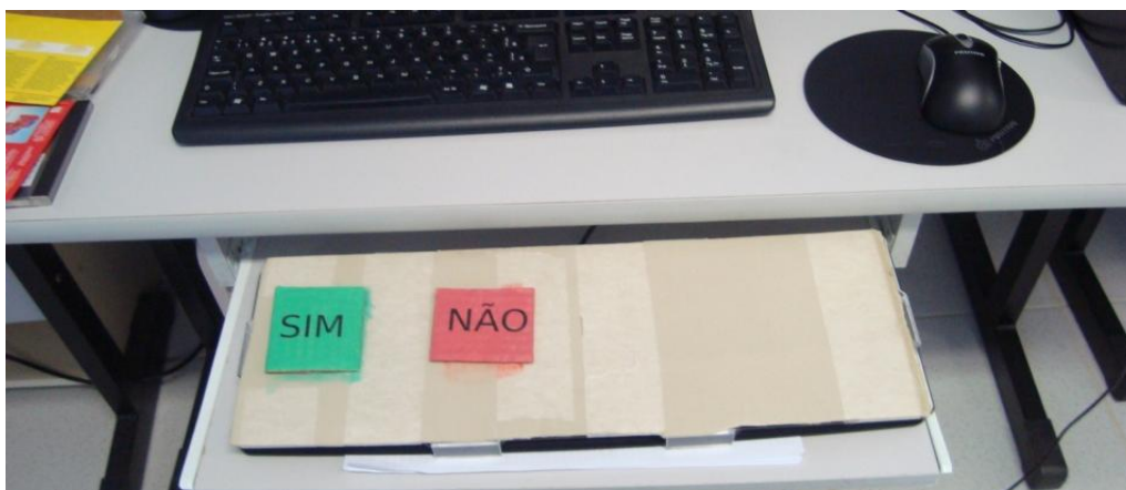
Figura 53. Cobertura para colméia para uso com software criado pelo professor para estabelecer comunicação com o aluno Kevin com o uso do computador.
