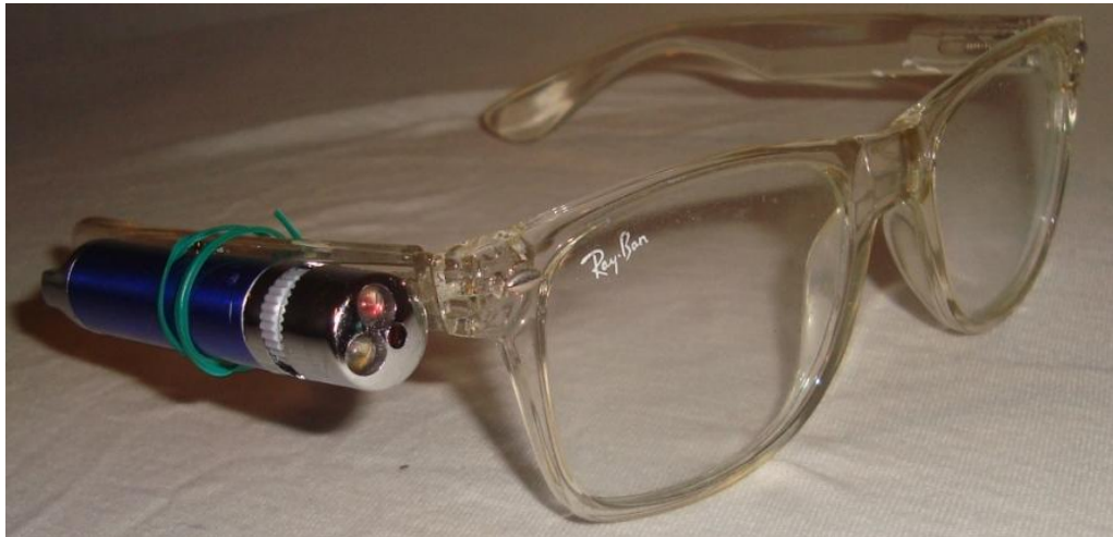
Figura 9 - Armação de óculos com dispositivo de luz e laser fixado à armação. Fonte: Arquivo da pesquisadora.
