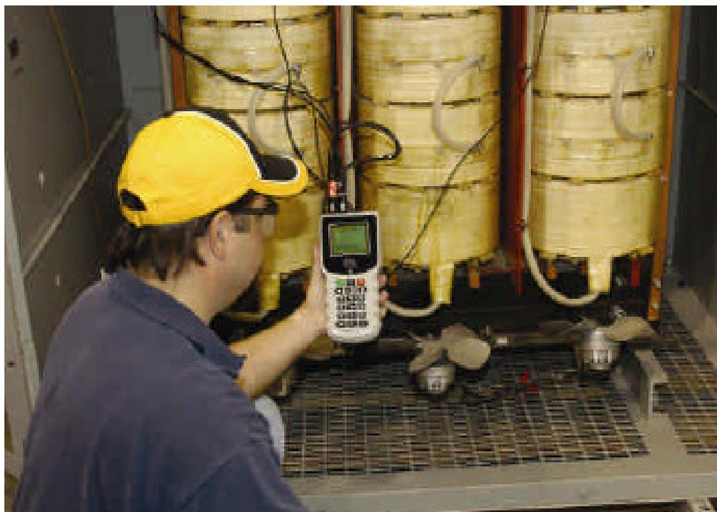
**Figura 3.10. Medição de relação de transformação (Garcia, 2005).**
