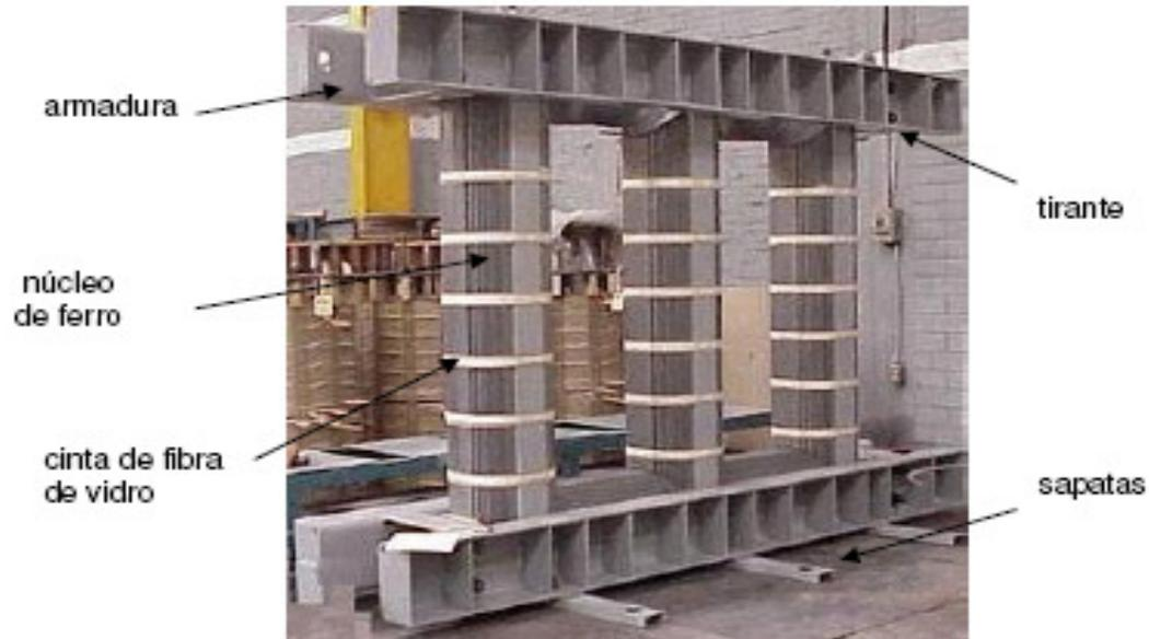
**Figura 3.2. Núcleo de um transformador trifásico (Demartini, 2007).**
