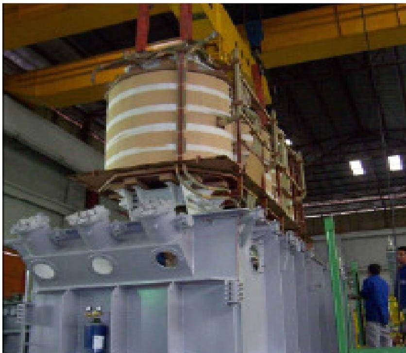
**Figura 3.7. Colocação da parte ativa no tanque (Demartini, 2007).**
