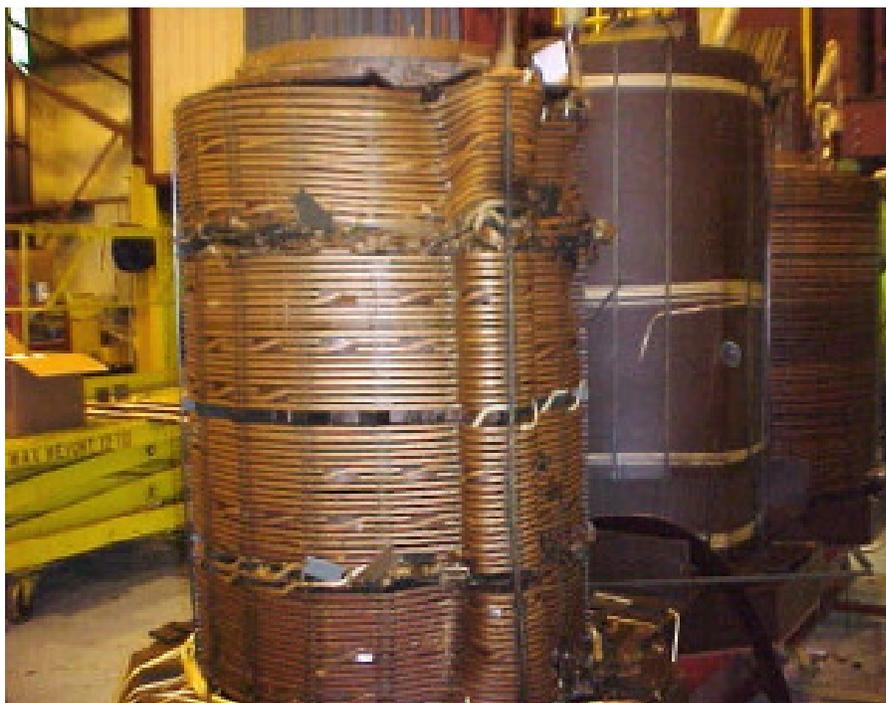
**Figura 3.11. Defeito constatado no enrolamento através do ensaio (Demartini, 2007).**
