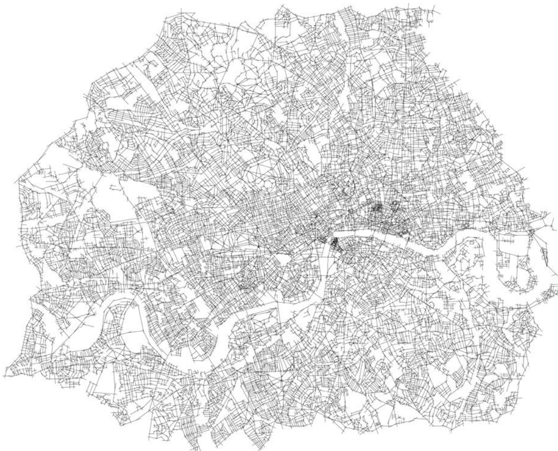
Figura 05: Cidade de Londres: representação do sistema urbano por intermédio de um mapa de eixos elaborado a partir de seus espaços públicos abertos – linhas representando ruas, eliminação das formas construídas. (FONTE: Space is the machine | Bill Hillier, 1999 - pág. 121).
