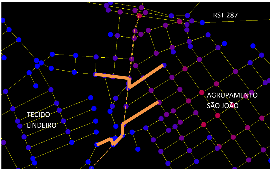
Figura 24: Em pontilhado Rua Buarque de Macedo – um dos acessos municipais e via receptora de tecidos desencaxados. Em destaque algumas transposições necessárias para acessar tecidos lindeiros – nós encadeados com três relações, ruptura do sistema e sobrecarga na via. (FONTE: software Morphometrics).
