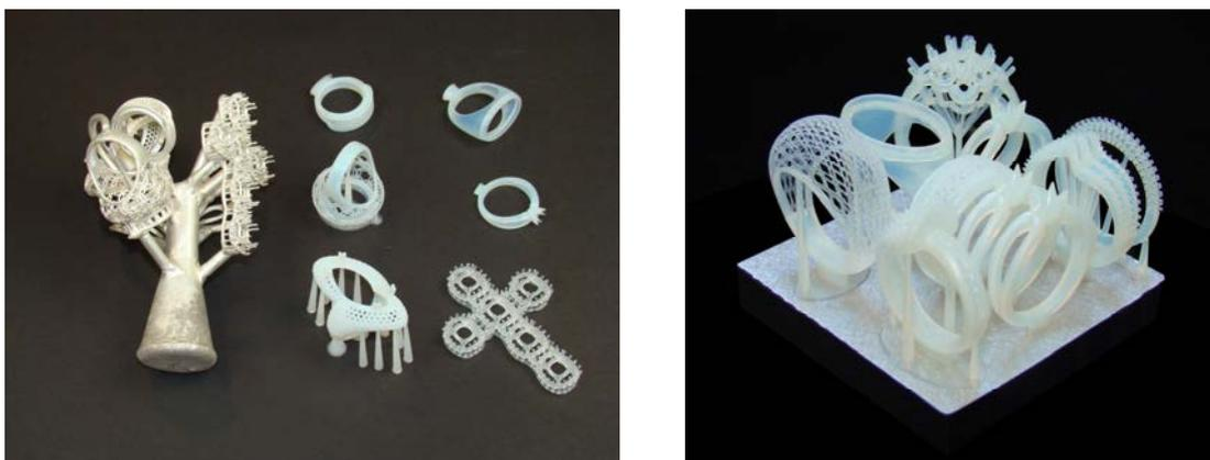
**Figura 10 – Modelos confeccionados em equipamento de PR de alta resolução (BQZ, 2010).**
