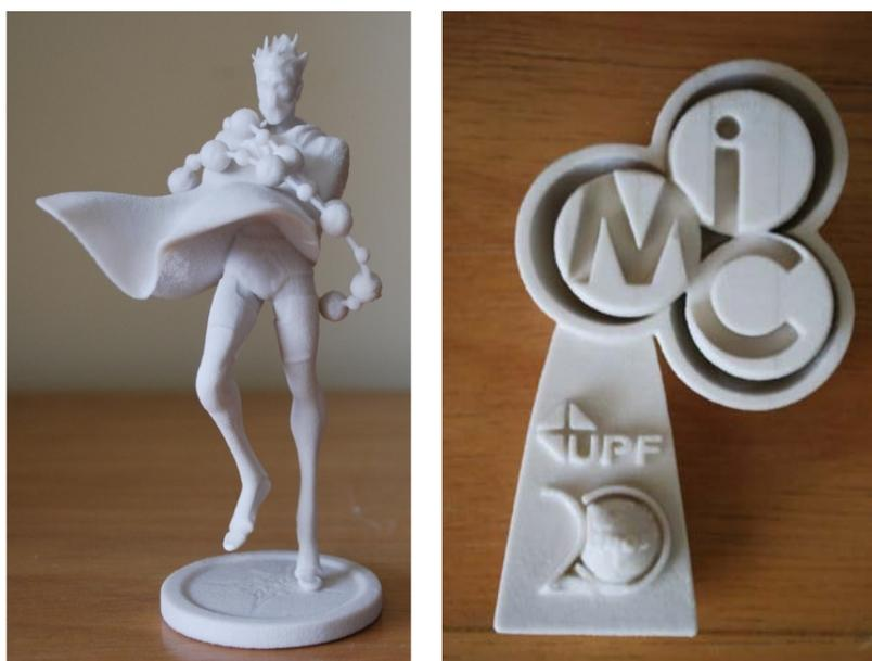
**Figura 13 – Peças fabricadas utilizando o sistema 3DP.**
