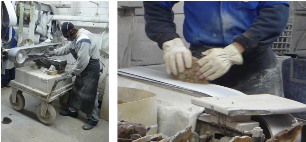
Figura 7 – Lixamento e polimento de ágatas em empresa de Soledade/RS.
