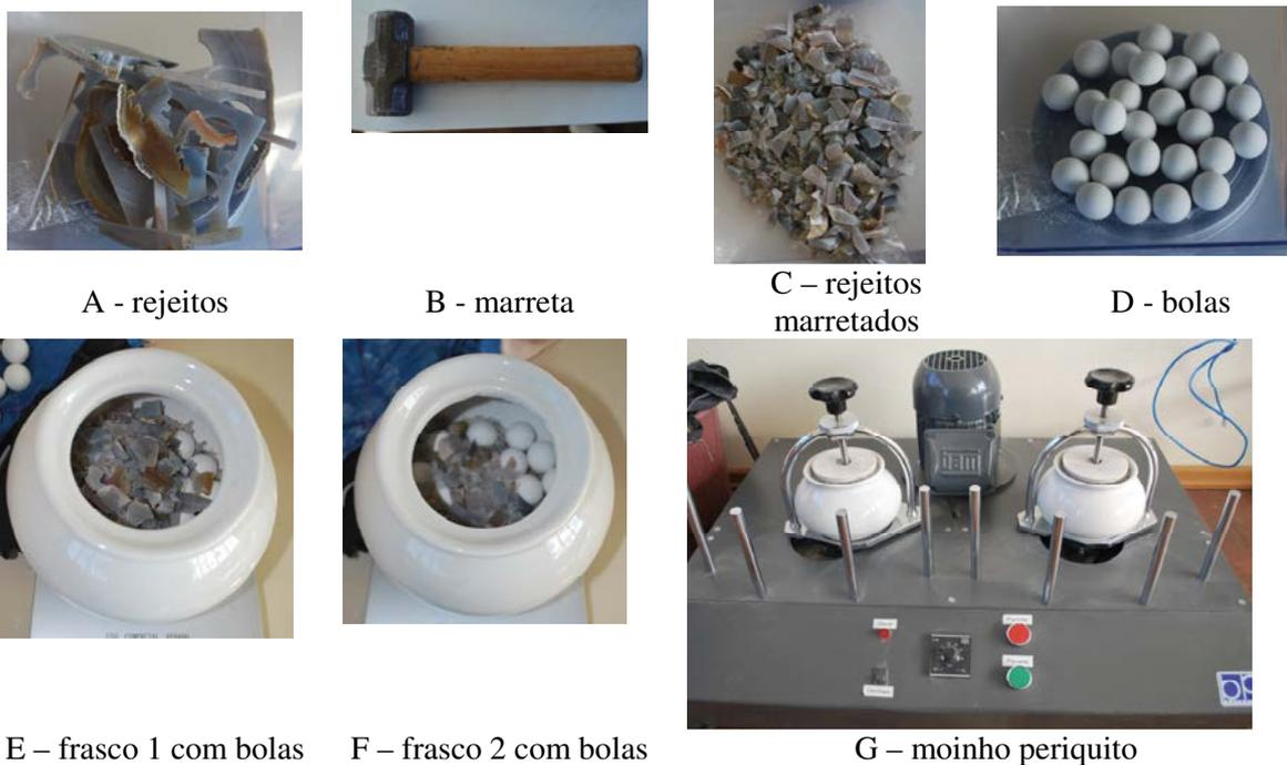
**Figura 16 – Processo de moagem dos rejeitos de ágatas.**
