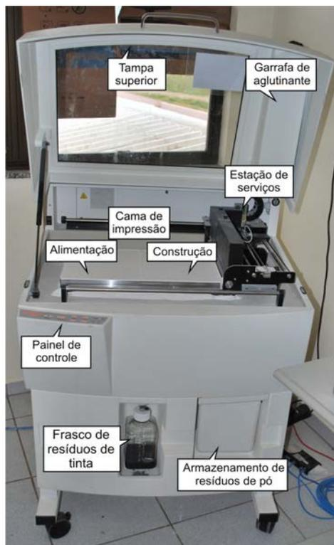
**Figura 15 – Componentes da unidade de fabricação.**
