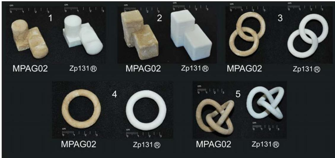
**Figura 35 – Peças fabricadas para análise geométrica.**
