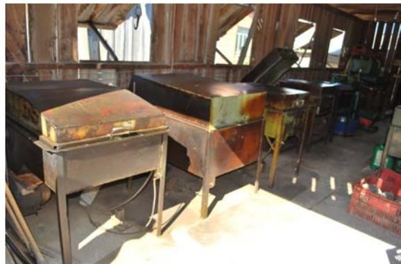
B – Conjunto de máquinas de serrar instaladas em uma fabriquetta de Soledade/RS.
