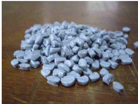
Figura 2 - Grânulos de polietileno de baixa densidade ( beads ), flutuam na água e servem como meio filtrante para a formação de biofilme.
