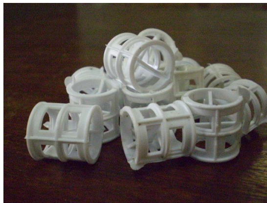
Figura 1 - Pall-rings utilizados na composição do filtro para o experimento de recirculação com tilápias do Nilo, no ano de 2008 por setenta dias.
