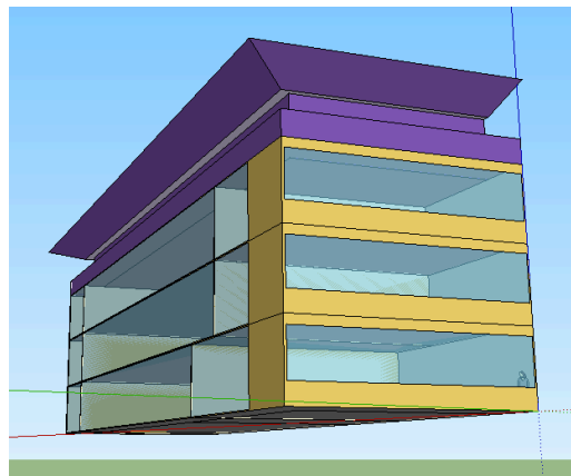
Figura 4.2: Perspectiva do modelo do Google Sketchup 8 para as salas da fachada norte do 3º, 4º e 5º pavimentos.
