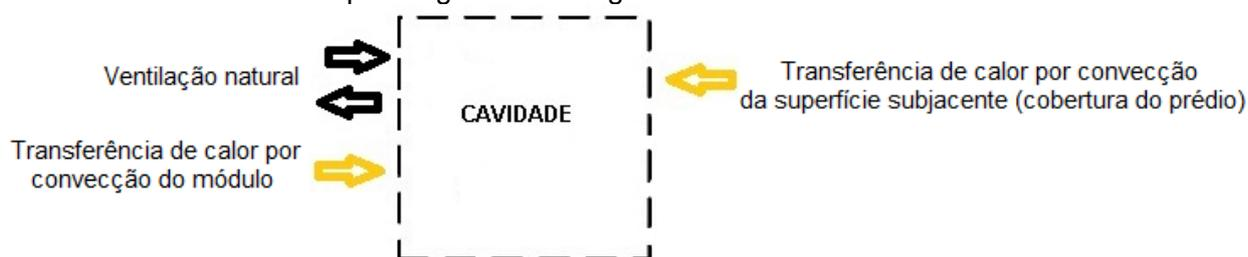
Figura 5.4 – Balanço de energia para o ar no interior da cavidade
