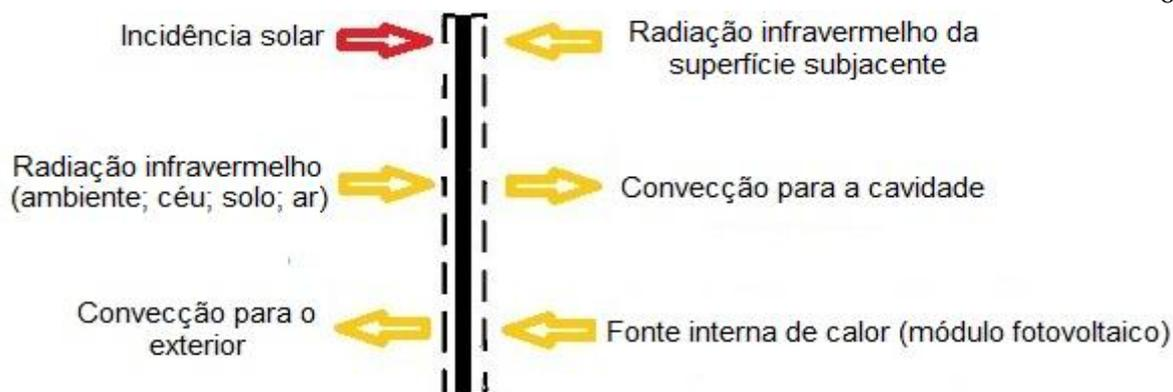
Figura 5.3 – Balanço de energia no módulo fotovoltaico
