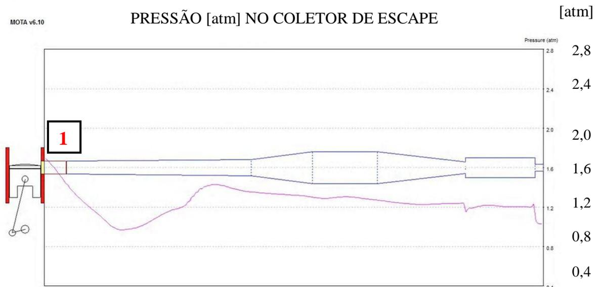
Figura 5.2 – Onda de pressão de retorno no fechamento da janela de escape
