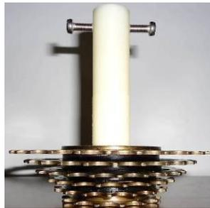
Figura 4.3 - Peça que conecta a catraca ao eixo do freio eletromagnético.
