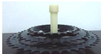
Figura 4.4 - Peça que conecta a coroa ao eixo do motor.
