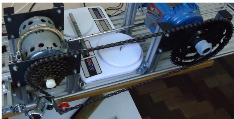
Figura 4.2 - Bancada utilizada para a medição de rendimento mecânico do sistema de transmissão de bicicleta.
