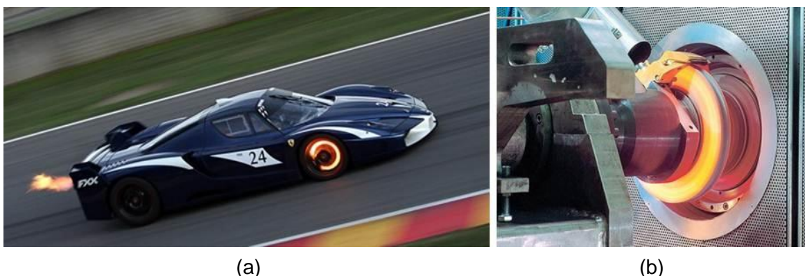
Figura 1.1 – Aumento da temperatura do sistema de freios (a) em uso real; (b) em ensaio
