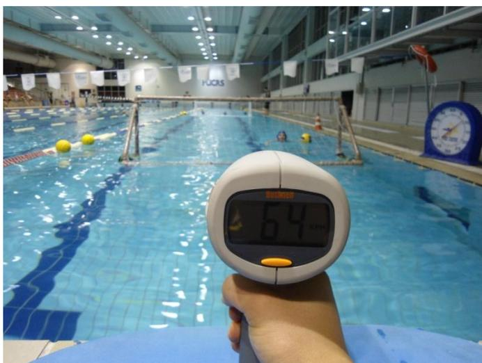
Figura 3 – Posicionamento do radar 5 m atrás da goleira de arremesso.
