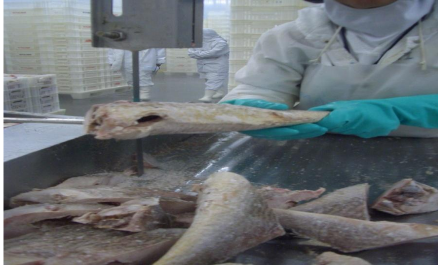
Figura 9: Corte vertical em serra-fita para posteamento de corvinas. Direitos autorais: Greice Franzon.
