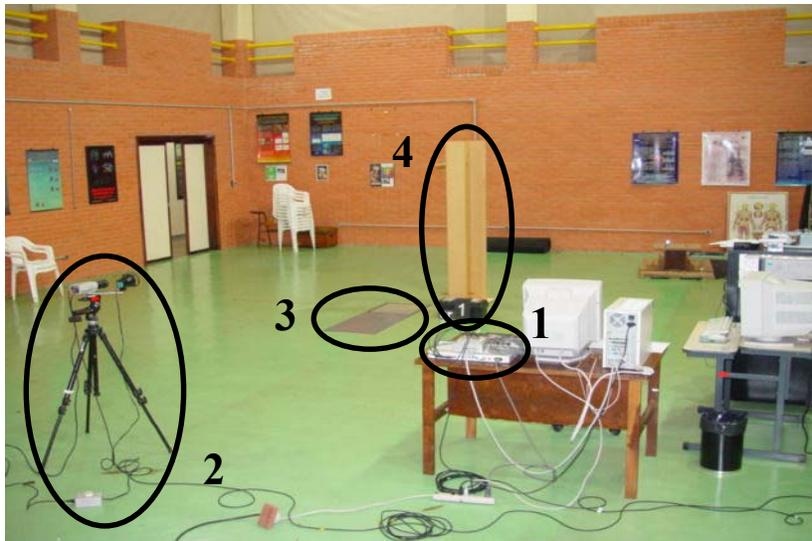
**Figura 9 - Sala pronta para coleta de dados. (1) eletromiógrafo; (2) câmera do sistema *Peak Performance*; (3) plataforma de força e (4) estante regulável**
