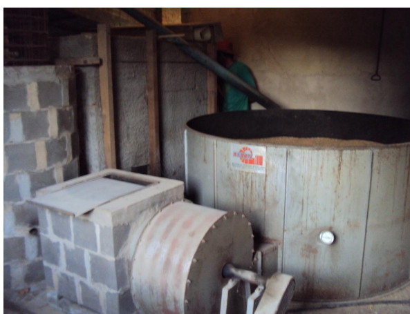
Figura 49 - Secador de grãos, utilizado para secar erva-mate. Santo Antônio do Palma, RS. Ano 2010. Fonte: acervo do autor.
