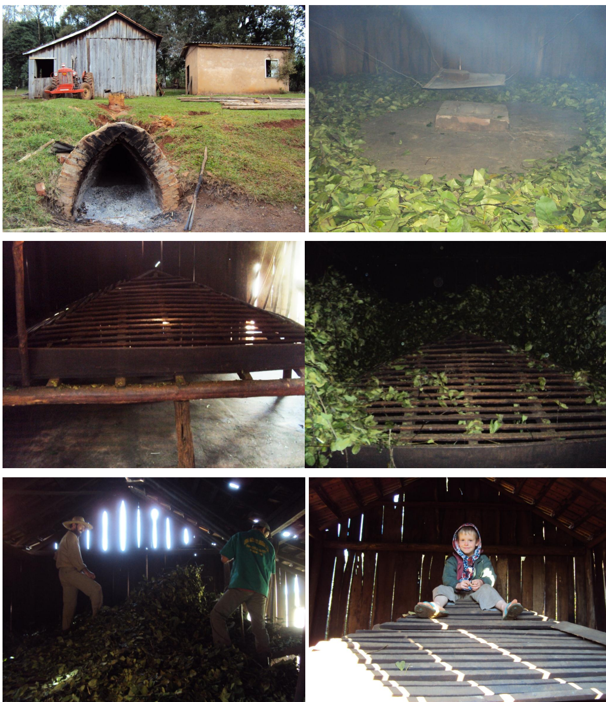
Figura 46. O barbaquá. Da esquerda para a direita e do alto para baixo: A) Moquem do barbaquá, onde se faz o fogo, que é conduzido por um túnel até o galpão, dentro do qual estão os ramos de erva-mate, para serem secados, Seberi. B) a boquia, por onde ascende o calor para dentro do galpão, situada no chão do galpão, abaixo da arapuca, Seberi. C, D, E) Arapuca de madeira piramidal, sobre a qual se dispõe os ramos de erva-mate para serem secados, Seberi. F) Menino sobre a arapuca em Santo Antônio do Palma. Ano 2010.
