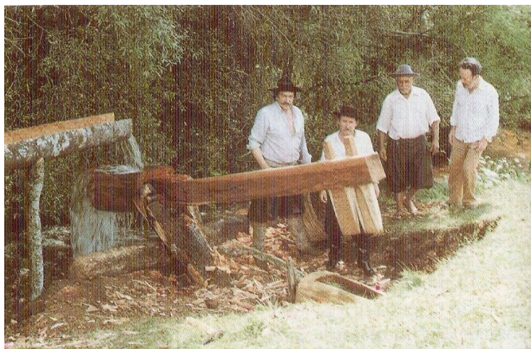
Figura 9 - Monjolo, situado a beira de um curso d'água. Fonte: Berkai e Braga (2000).
