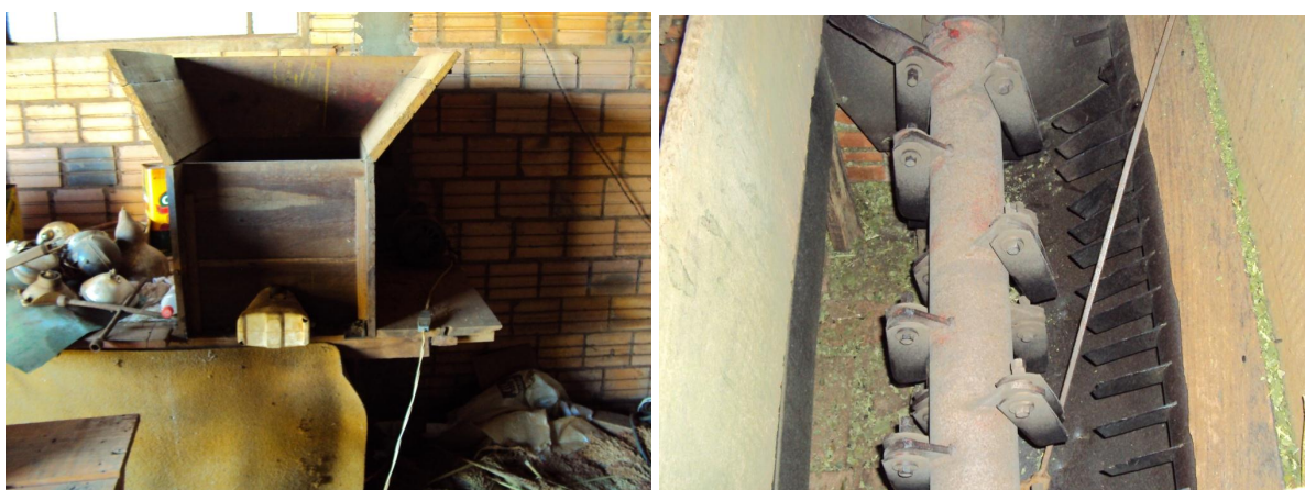
Figura 57. A) e B) Cancheamento da erva-mate em máquina com barras metálicas, sendo tracionada com energia elétrica. Lagoa dos Três Cantos e Humaitá, respectivamente. RS. Ano 2010.
