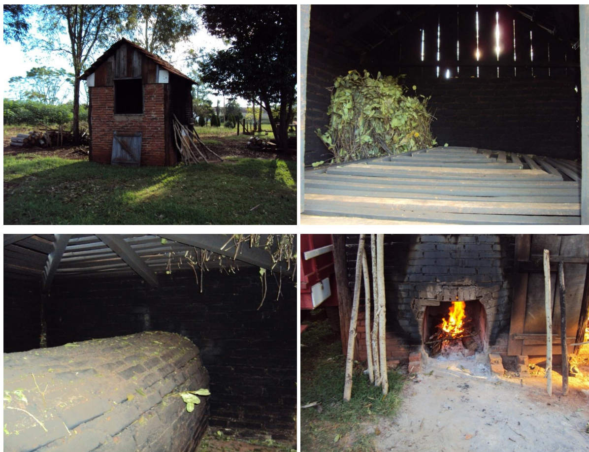
Figura 47 - O secador em Humaitá, RS. Da esquerda para a direita e do alto para baixo: A) o forno . B) Ramos de erva-mate secos, dispostos verticalmente sobre a arapuca de madeira do forno . C) Visão abaixo da arapuca, mostrando a estrutura de tijolos, dentro da qual a lenha é queimada. D) Visão externa do forno , mostrando o local onde se queima a lenha. Ano 2010.
