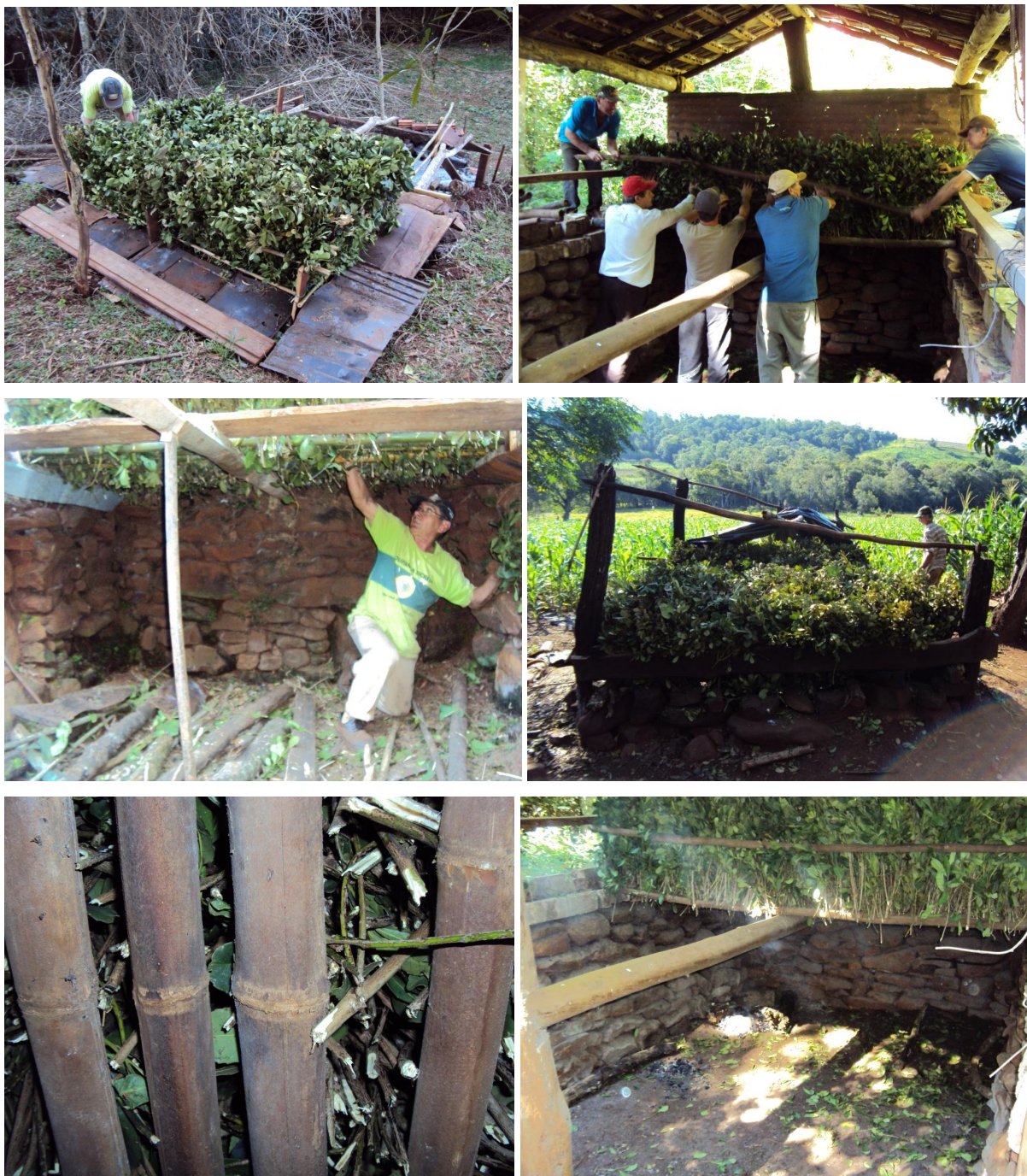
Figura 42 - A disposição dos ramos de erva-mate sobre o cariço. Da esquerda para a direita e do alto para baixo: A) Cariço com os ramos de erva-mate, e suas bordas vedadas, para o máximo aproveitamento do calor, Panambi. B) pondo os feixes de erva sobre o cariço, Bozano. C) retirando ramos de erva, que estão muito abaixo do estrado, para evitar o risco de incêndio do cariço, Panambi. D) Cariço com os feixes de erva, Santo Cristo. E) Visão em detalhe da face embaixo do estrado de taquara, mostrando seu espaçamento e os ramos de erva, Bozano. F) O cariço com os feixes de erva, dispostos verticalmente, Bozano. Ano 2010. Fonte: acervo do autor.
