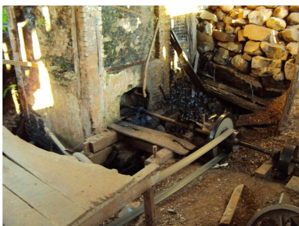
Figura 59 - O soque no Rio Grande do Sul. Da esquerda para a direita e do alto para baixo: A) Soque com seis mãos-de-pilão, movido a energia elétrica, Seberi. B) Soque com duas mãos-de-pilão metálicas, à energia elétrica, Panambi. C e D) Pondo os ramos de erva-mate no cocho do soque, o qual é movido com energia de motor à combustão, Santo Cristo. E) Turbina d'água, fonte de energia do soque, Humaitá. F) Casa do soque, que é movido com roda d'água, Bozano. Ano 2010.
