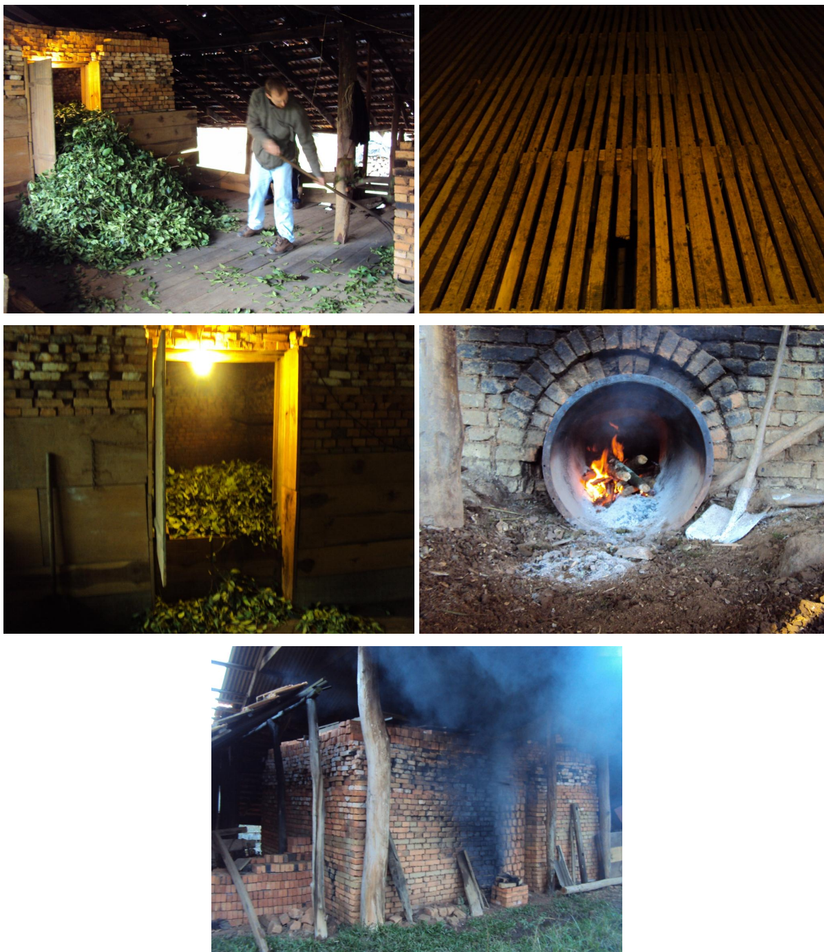
Figura 48 - Secador em Ipê, RS. Da esquerda para a direita e do alto para baixo: A) Recolhendo os ramos de erva-mate sapecados, para serem dispostos na entrada do secador. B) Estrado plano de madeira, onde se dispõe os ramos de erva-mate, para serem secados. C) Visão do interior do secador, com os ramos de erva-mate. D) Local onde se queima a lenha, dentro de um cilindro de metal, localizado abaixo do estrado. E) Visão do secador, do local onde há uma chaminé. Ano 2010.
