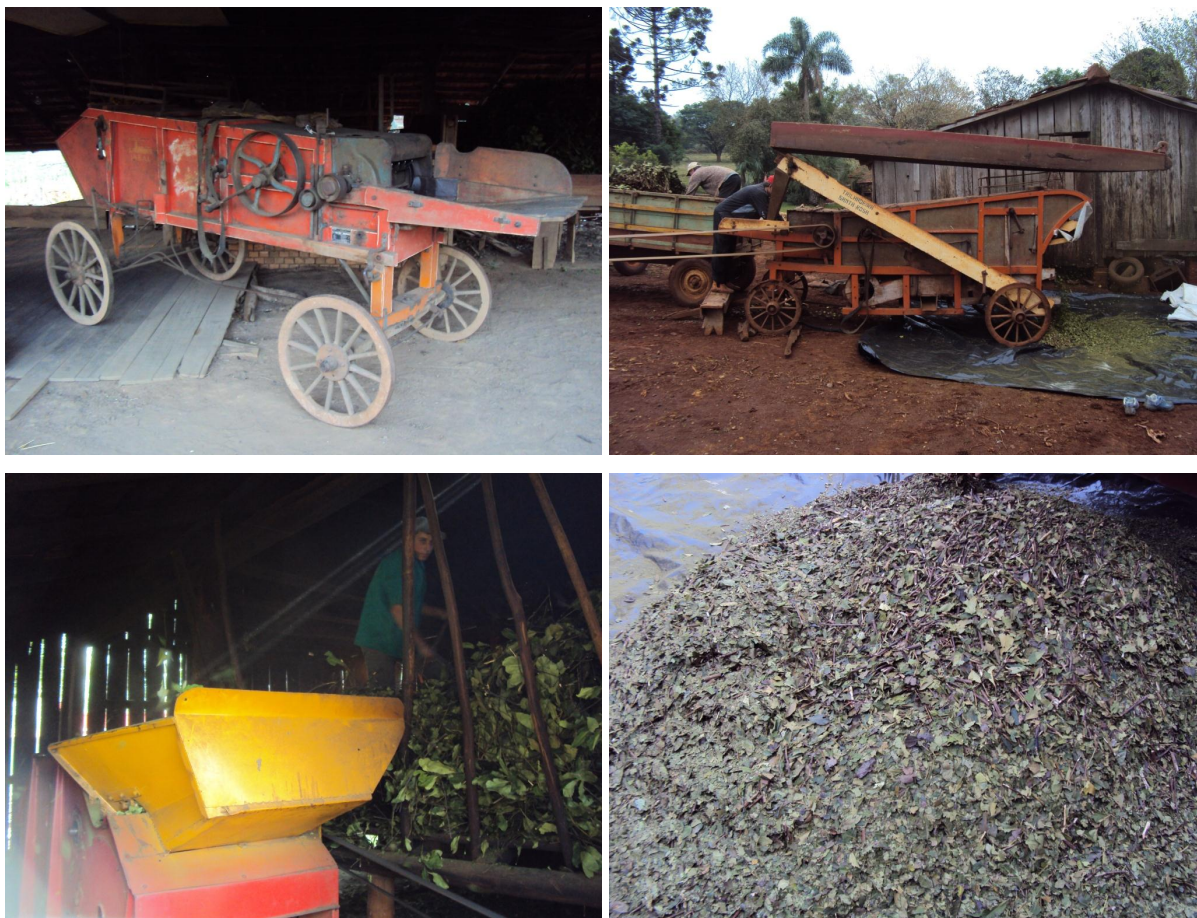
Figura 56 - Da esquerda para a direita e do alto para baixo: A) Trilhadeira, em Ipê. B) Cancheamento da erva-mate em trilhadeira, em Bozano. C) Cancheamento em motriz de colheitadeira adaptada, Seberi. D) Detalhe da erva cancheada por trilhadeira, em Bozano. RS. Ano 2010.
