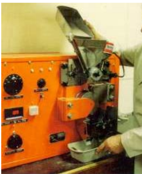
Figura 14: Separador magnético de rolo induzido. Fonte: Catálogo Carpcó.
