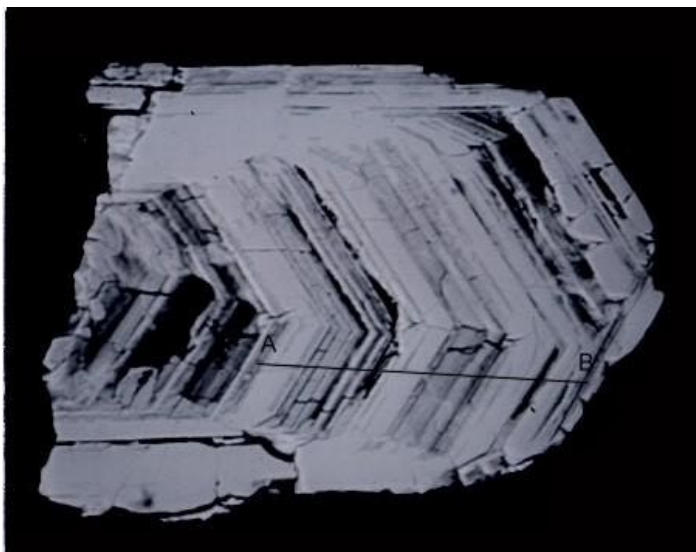
Figura 30: Imagem BSE de zircão metamitizado. AB corresponde à varredura de elétrons em microsonda.
