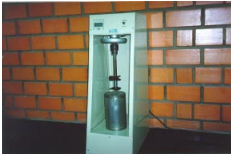
Figura 10: Célula de atrição usada em bancada de laboratório.
