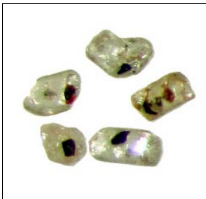
Figura 41: Zircões quebrados durante a moagem, com inclusões minerais expostas.
