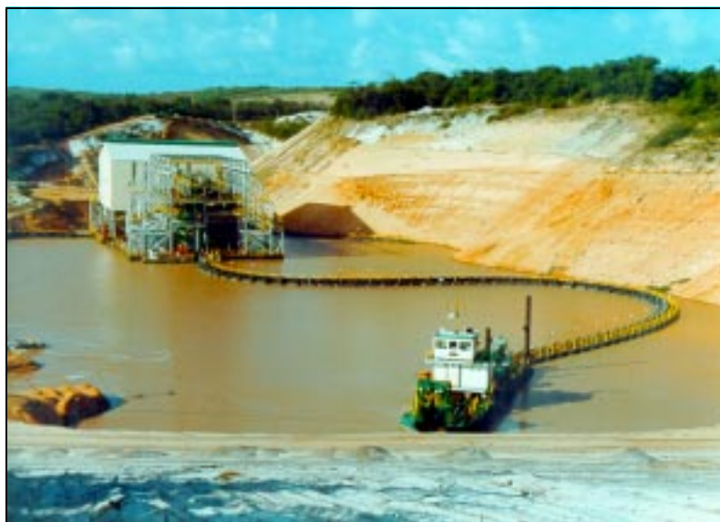
Figura 2: Lavra da jazida por draga bucket wheel e a planta de pré-tratamento acoplada.
