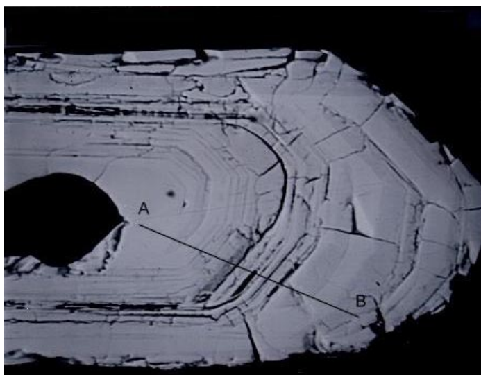
Figura 29: Imagem BSE de zircão metamitizado. AB corresponde à varredura de elétrons em microsonda.
