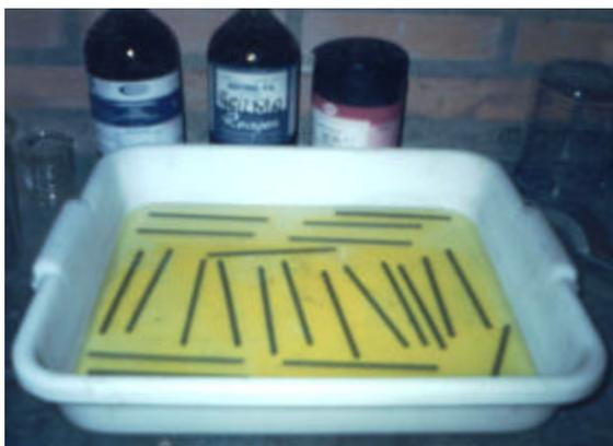
Figura 14: limpeza das barras de aço com solução de ácido clorídrico e água deionizada
