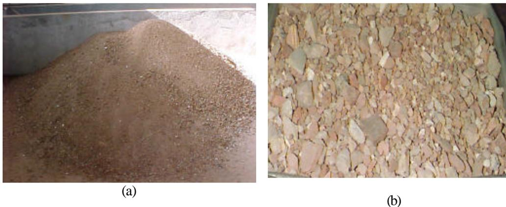
Figura 10: agregados reciclados utilizados. (a) Agregado miúdo. (b) Agregado graúdo
