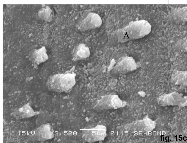
FIGURAS 15a, 15b e 15c. Fotomicrografias (3500X) das secções fraturadas (G2-E3) ao ensaio de união à microtração. Nota-se a presença de tags de compósito (A) na secção correspondente ao material restaurador e região de túbulos dentinários preenchidos com prolongamentos resinosos (B) na secção dentinária homóloga. Observa-se a ocorrência de ranhuras diagonais (C) provenientes do preparo cavitário pela utilização de uma ponta diamantada, caracterizando falha na região de camada híbrida (tipo II).
