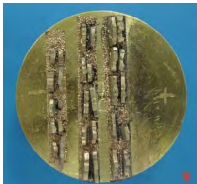
FIGURA 6. Espécimes fraturados metalizados em stubs para análise do tipo de fratura ao MEV.
