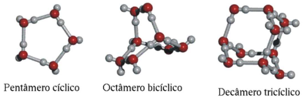
Figura 1.6: Estruturas formadas pelas moléculas de água Os aglomerados de moléculas com estruturas icosaédricas podem ser formados por pentâmeros cíclicos, octâmeros bicíclicos e, ainda, decâmeros tricíclicos.
