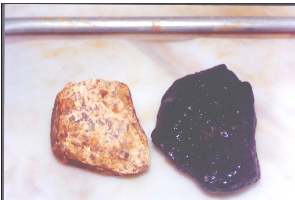
Figura F.24 – Contraste entre pedras não utilizada no experimento (esquerda) e proveniente do meio suporte de um dos reatores da Subfase A.3
