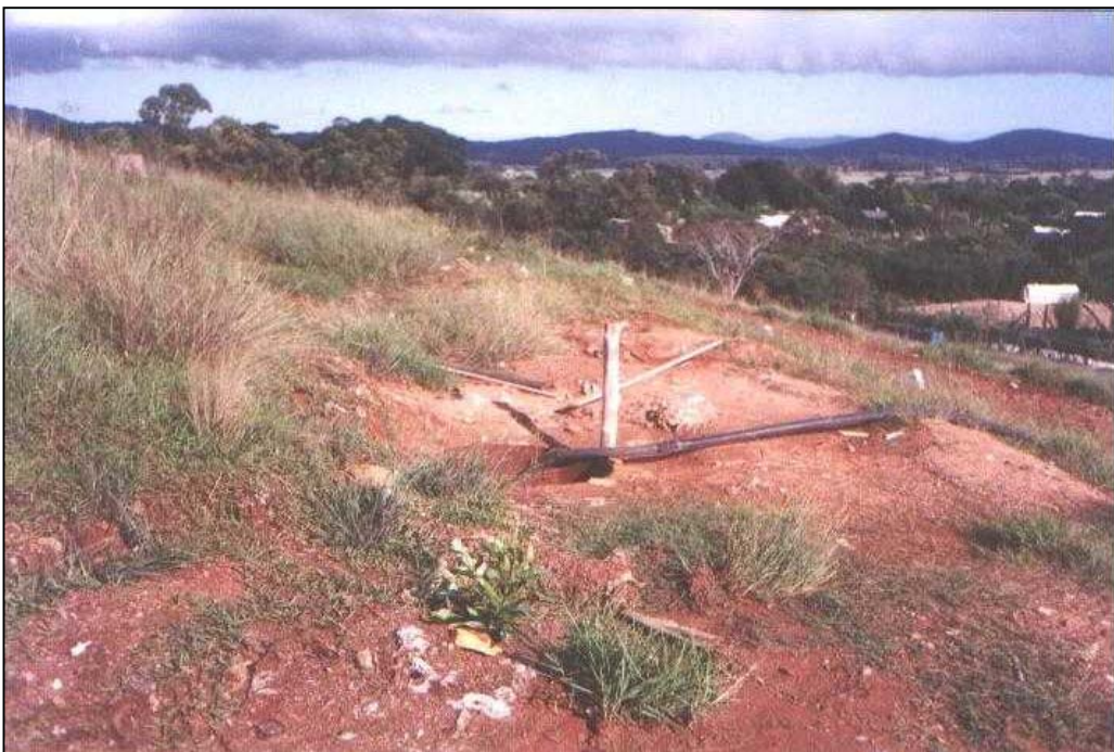
Figura F.32 – Vista do poço de lixiviado utilizado na Subfase B.1 do experimento, sito no Aterro Sanitário Extrema, Porto Alegre
