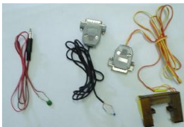
Fig.7- As esquerda para direita: NTC, PTC e sensor ótico.
