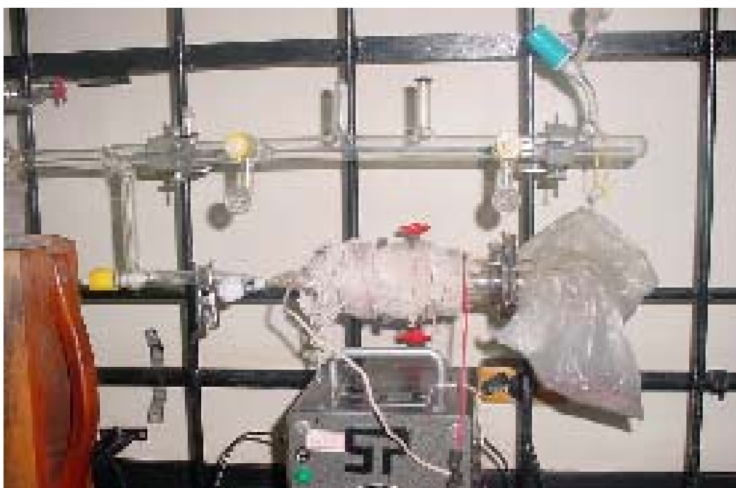
Figura 2. Aparato experimental para análise térmica no infravermelho, composto de cela de quartzo e linha de vácuo.
