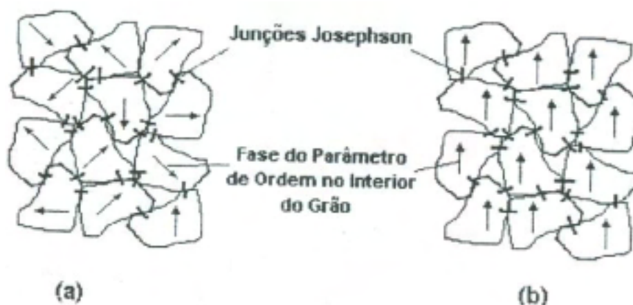
Fig. 4.2 – (a) Região paracoerente, T_{c0} < T < T_c , onde as fases do parâmetro de ordem GL flutuam intensamente. (b) Região coerente, T \leq T_{c0} , ordem de longo alcance na fase do parâmetro de ordem e resistividade nula.
