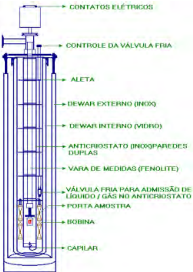
Fig. 5.15 - Sistema criogênico com bobina de cobre utilizado em medidas de magnetoresistividade.
