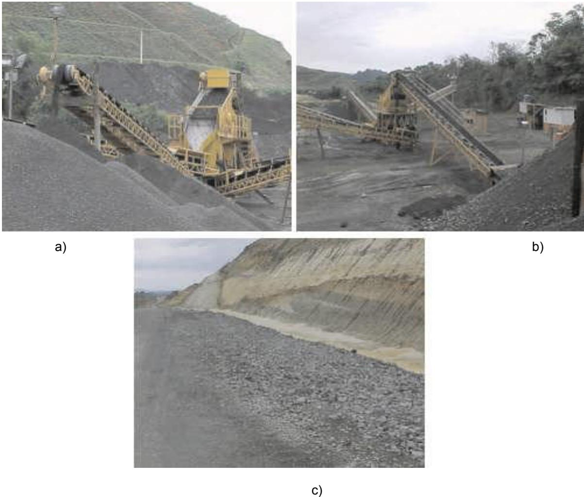
**Figura 2.14** Construção do contorno da cidade de Volta Redonda – RJ: a) e b) sistema de peneiramento da escória da aciaria LD; c) escória de aciaria LD lançada como base
