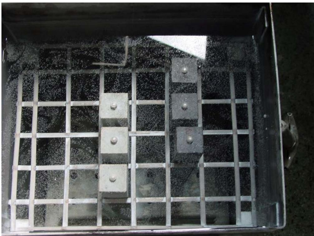
**Figura 7.4** Ensaio da Expansibilidade pelo método adaptado das barras
