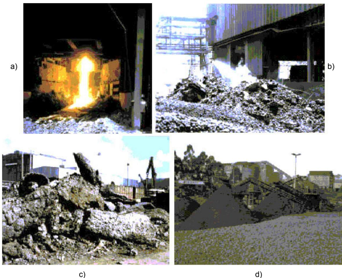
**Figura 2.10** Escória de aciaria elétrica: a) vazamento da escória; b) resfriamento lento; c) escória sólida; d) sistema de britagem e recuperação da fração metálica.
