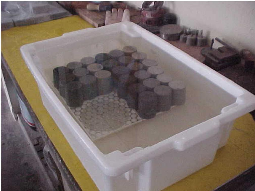
**Figura 8.39** Realização do ensaio de absorção de água por imersão (NBR 9778, 1987)
