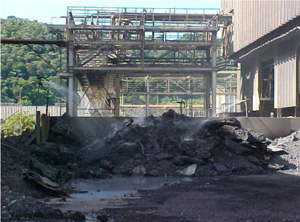
**Figura 2.9** Resfriamento ao ar da escória de aciaria: pequenos jatos de água arrefecendo a escória
