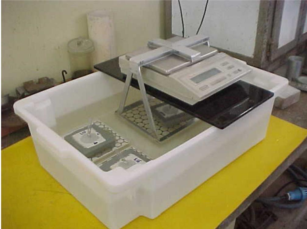
**Figura 8.23** Realização do ensaio de penetração de água por sucção capilar
