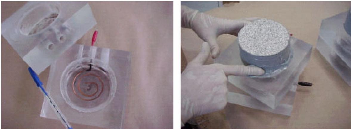
**Figura 8.49** Ensaio de migração íons cloreto: fixação do corpo-de-prova nas células com selante neutro de alta viscosidade
