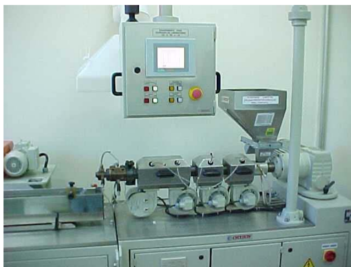
Figura 24: Fotografia da extrusora de rosca simples Oryzon com cinco diferentes zonas de aquecimento .
