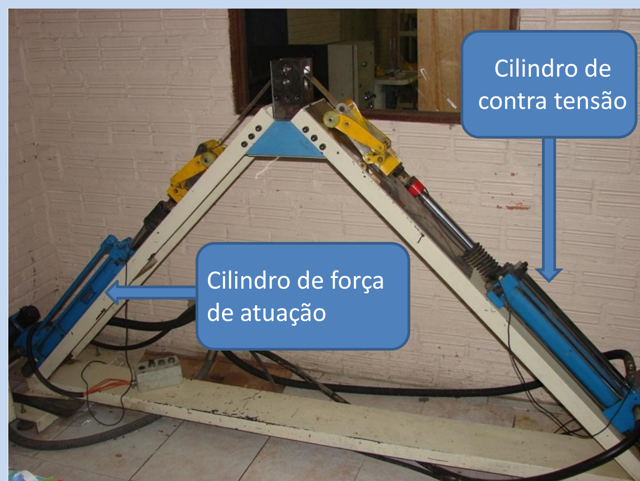
Figura 1: Sistema de avaliação do coeficiente de atrito.
